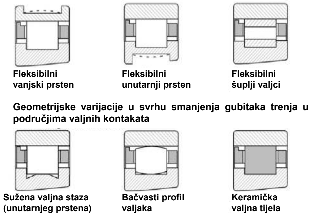
Slika 4.5. Konstruktivna rješenja ležajeva u svrhu smanjenja trenja [2]
