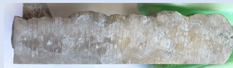
Slika 40. Ispitivanje u slanoj komori na uzorku 23
