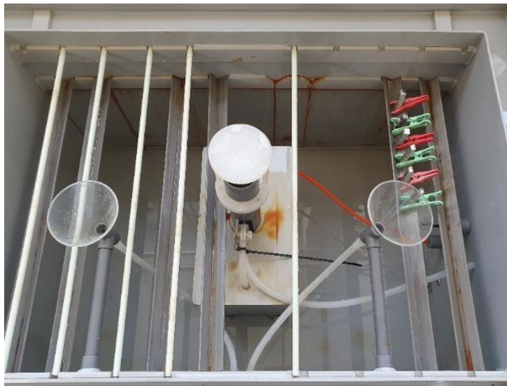
Slika 33. Uzorci postavljeni u slanu komoru
