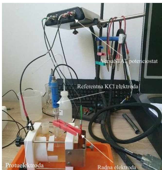
Slika 41. Ispitna elektrokemijska ćelija
