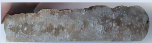
Slika 40. Ispitivanje u slanoj komori na uzorku 23
