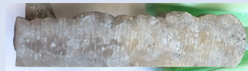
Slika 40. Ispitivanje u slanoj komori na uzorku 23
