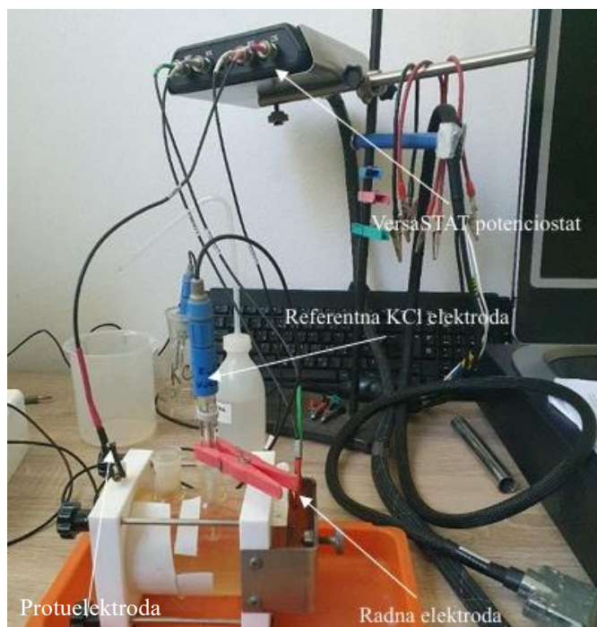
Slika 41. Ispitna elektrokemijska ćelija
