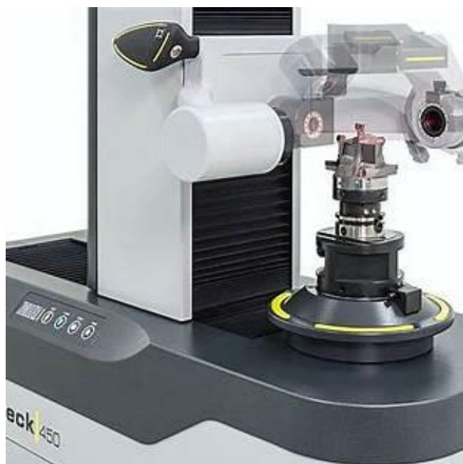
Slika 5. - Uređaj "SmartCheck" s rotacijskom kamerom za inspekciju alata [3]
