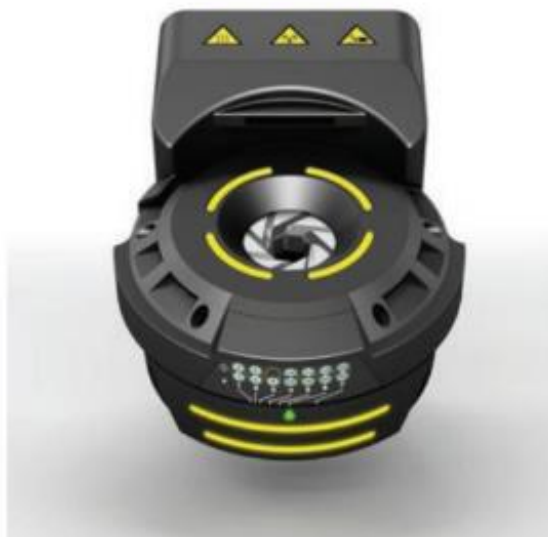
Slika 11. - Indukcijska zavojnica za termo – stezanje [2]
