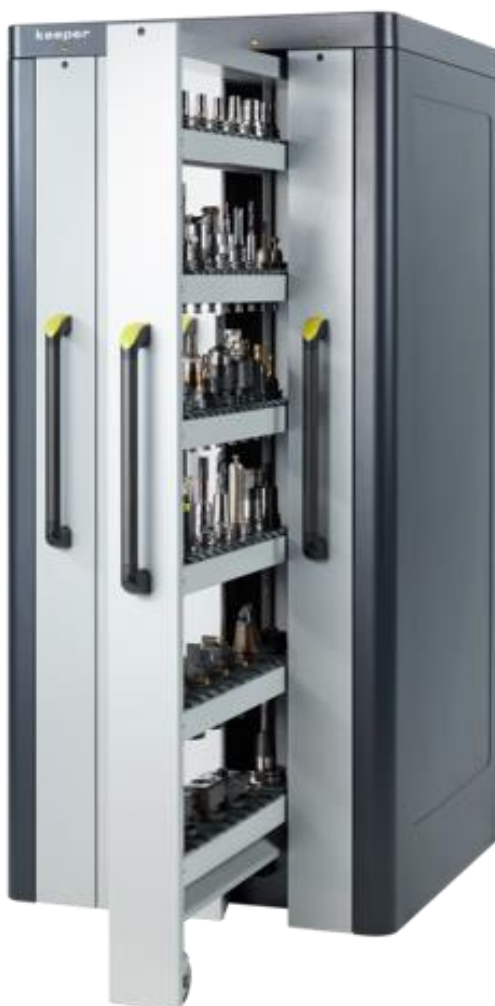
Slika 33. - Zollerov "Keeper" pametni ormar za upravljanje alatima [18]
