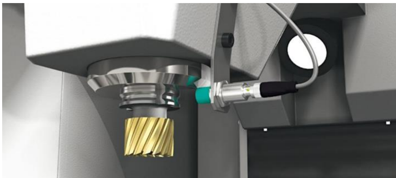
Slika 25. - RFID čitač u obradnom centru [18]
