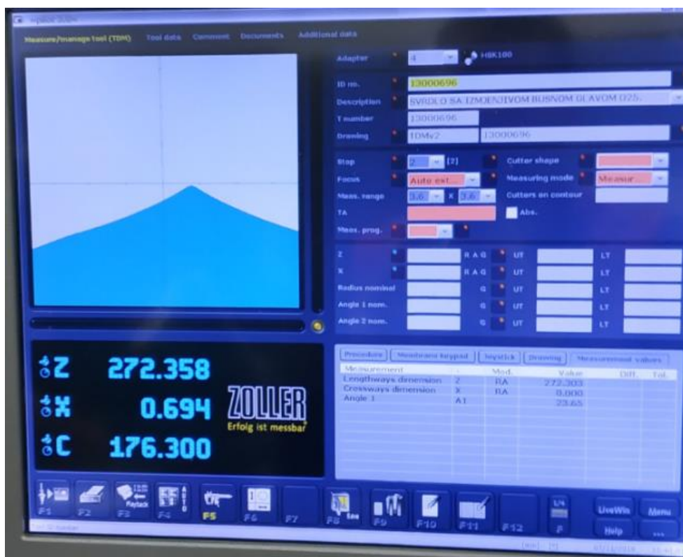
Slika 26. - Mjerenje dužine alata na vrhu svrdla
