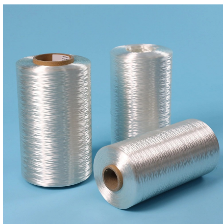
Slika 2.5: Rola staklenih S2 Glass vlakana [16]
