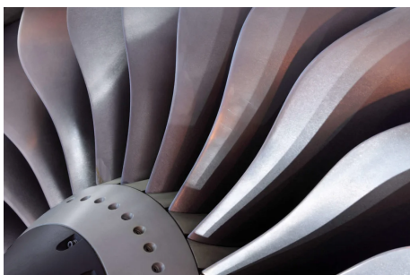
(a) Lopatice turboventilatorskog motora izrađene od CMC kompozita [5]
