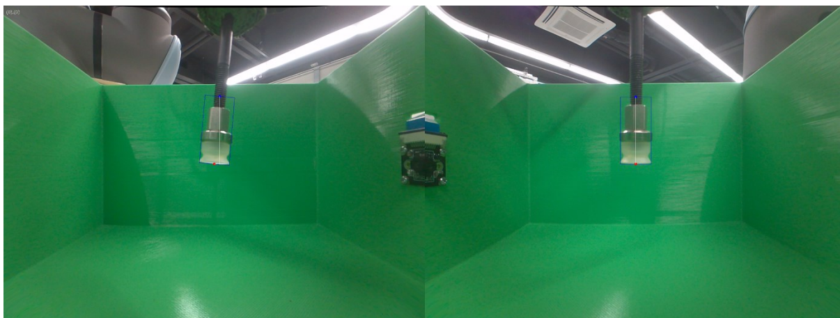
Slika 70. Slike sa obje kamere za poravnanje osi alata sa z osi baze robota - treći alat
