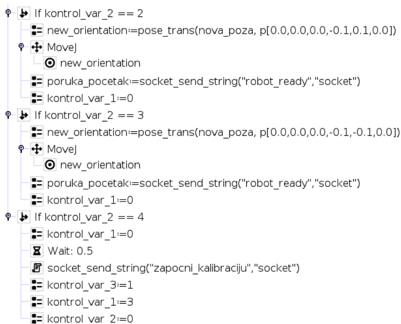
Slika 56. Dio programa za mijenjanje orijentacije alata robota
