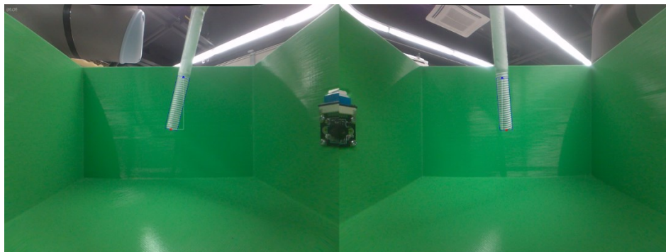
Slika 74. Slike sa obje kamere za poravnanje osi alata sa z osi baze robota - četvrti alat
