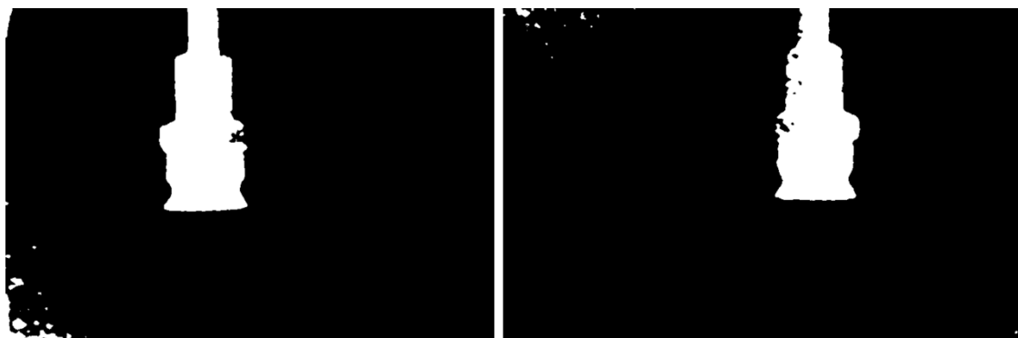
Slika 40. Segmentacija alata korištenjem OTSU metode
