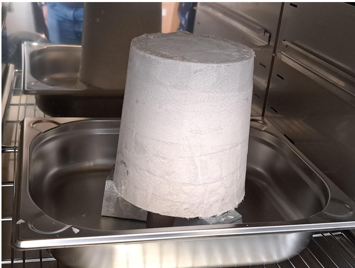
Slika 4.18. Gipsani kalup nakon sušenja
