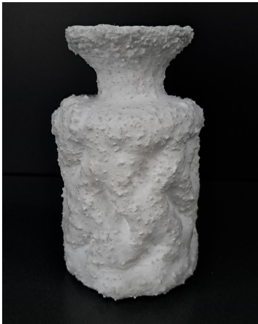
Slika 4.23. Osušena školjka proizvedena keramičkom suspenzijom na bazi natrijevog silikata
