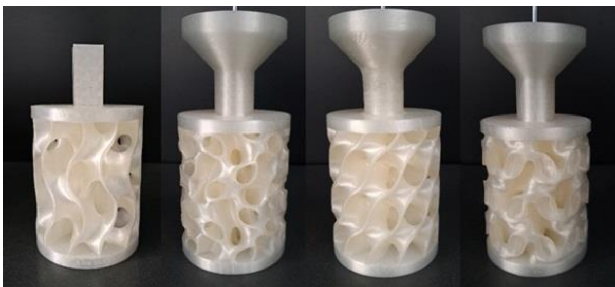
Slika 4.11. Pramodele izrađeni postupkom FDM u Polycast materijalu
