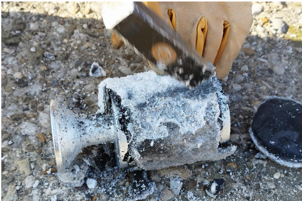
Slika 4.39. Razbijanje keramičke školjke
