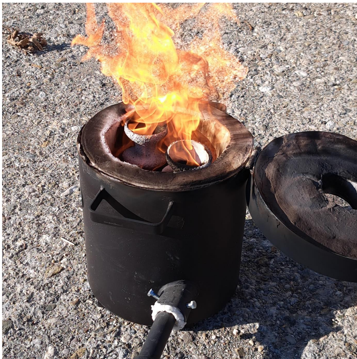
Slika 4.29. Izgaranje pramodela i žarenje keramičkih školjki
