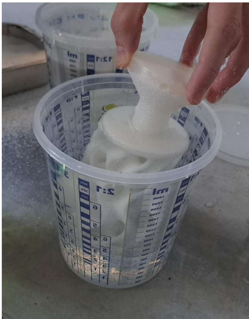
Slika 4.21. Uranjanje pramodela u kloridnu kupku
