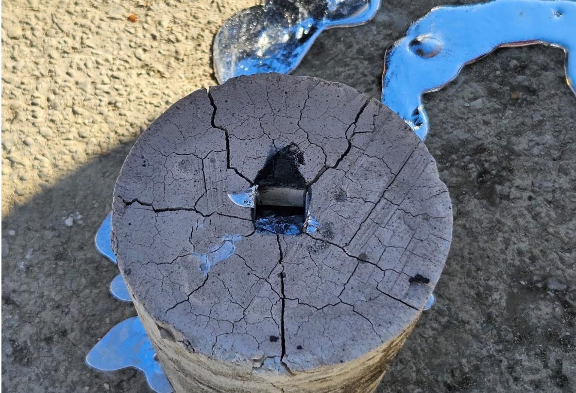
Slika 4.36. Rezultat lijevanja u gipsani kalup
