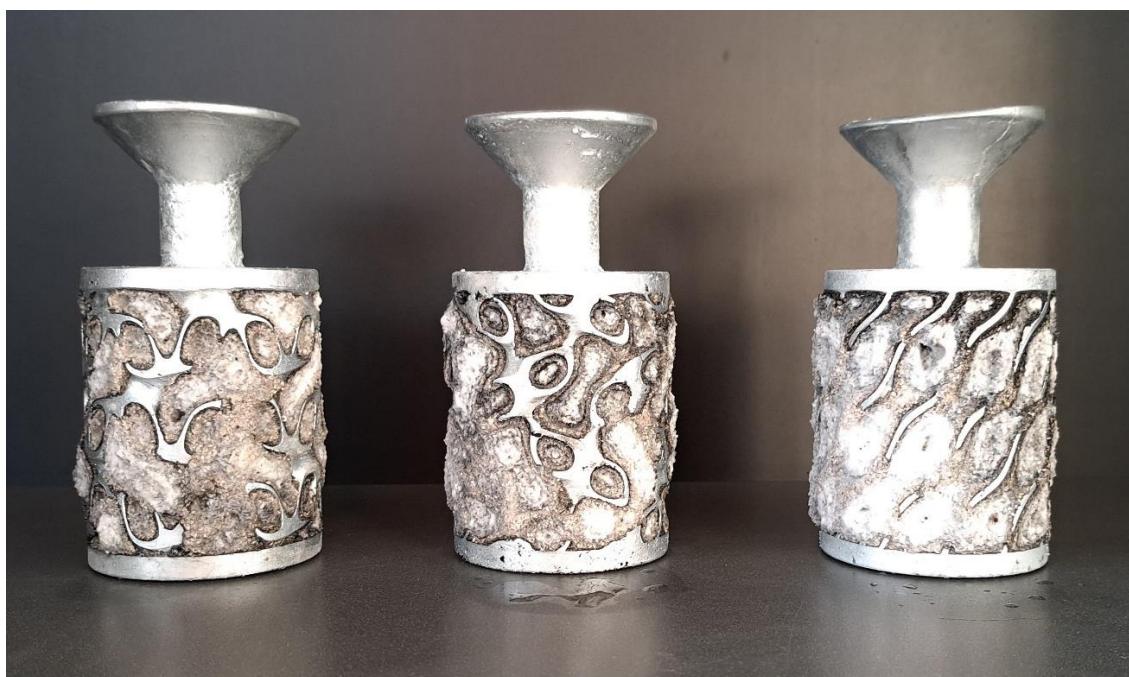
Slika 4.41. Odljevci lidinoidne, splitP i dijamantne strukture nakon grubog odstranjivanja keramičke školjke
