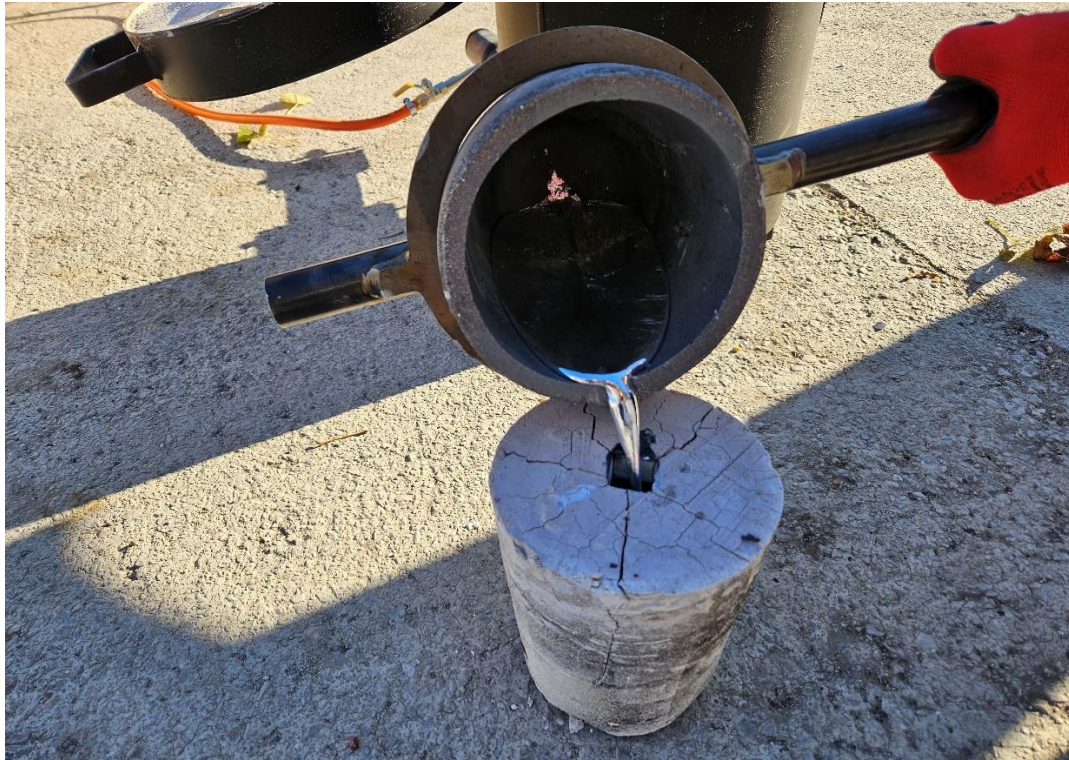
Slika 4.32. Lijevanje legure u gipsani kalup
