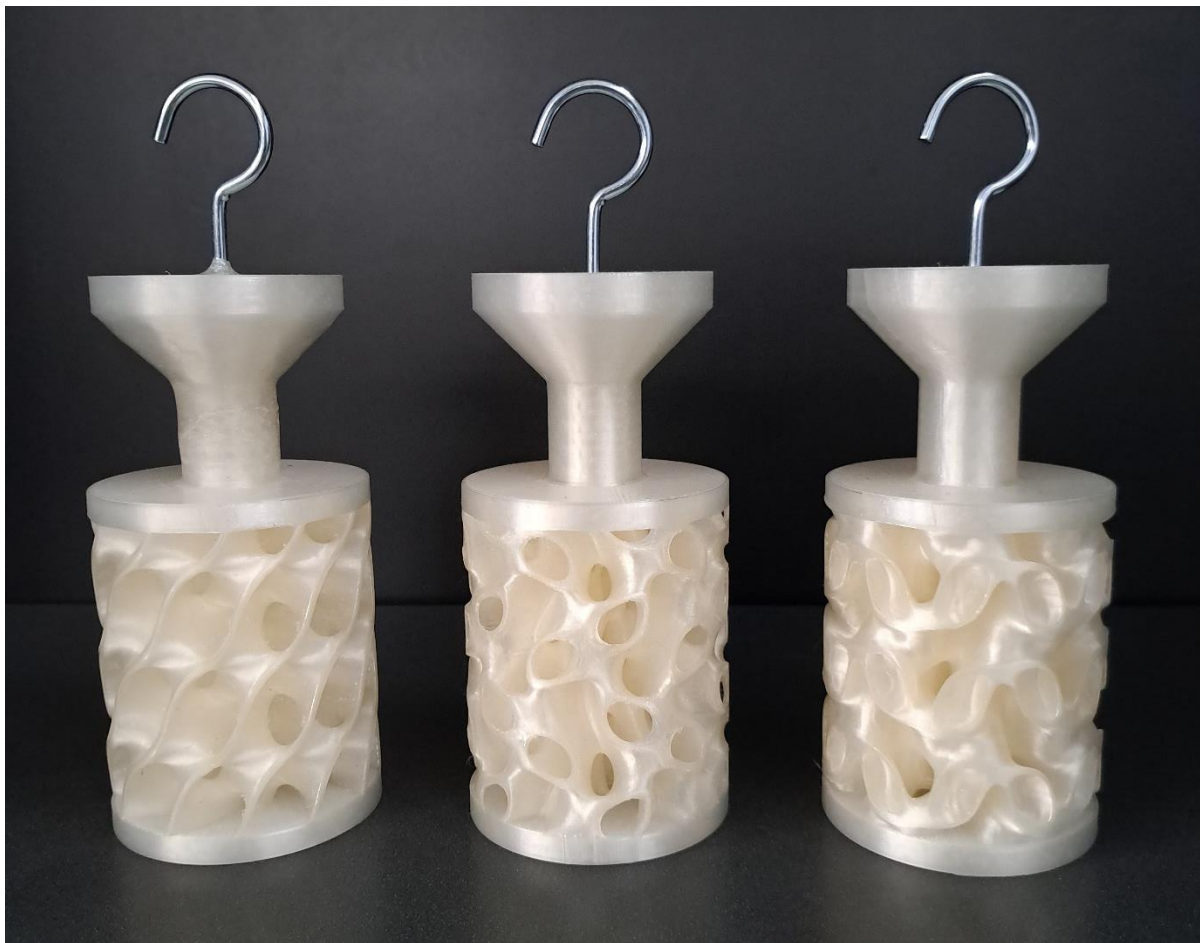
Slika 4.24. Pramodeli dijamantne, splitP i lidinoidne strukture
