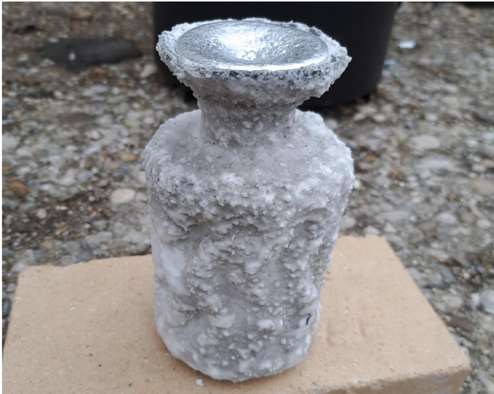
Slika 4.37. Rezultat lijevanja u keramičku školjku na bazi natrijevog silikata
