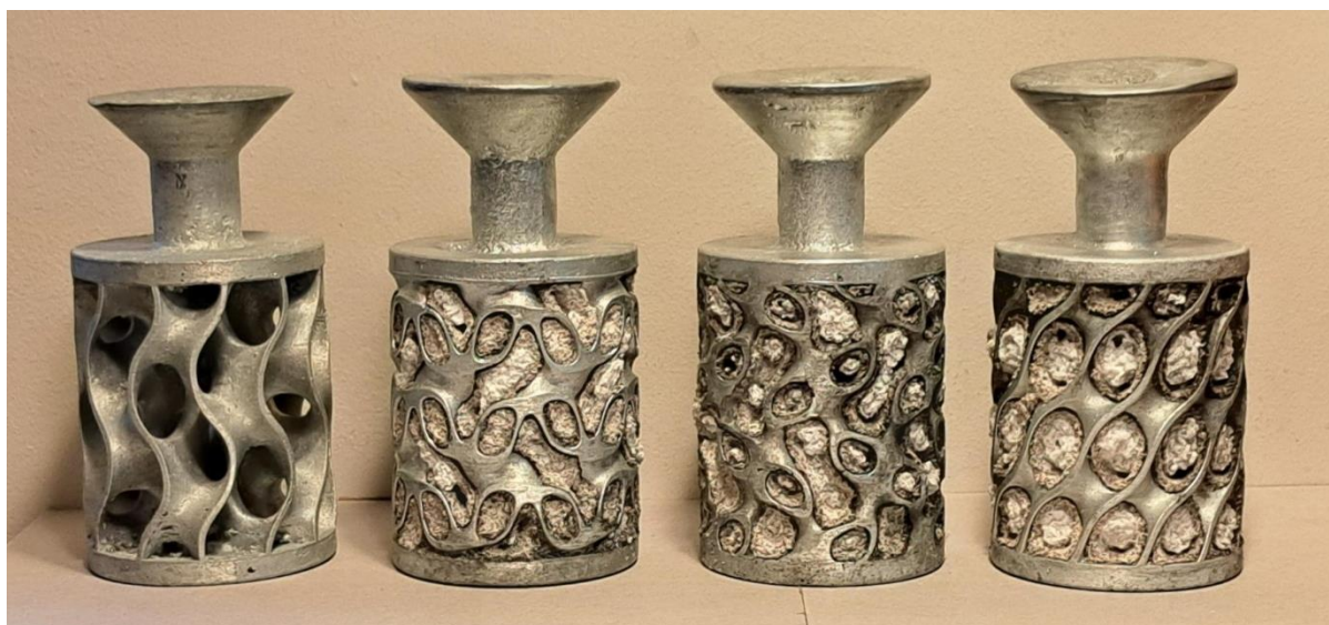
Slika 4.42. Odljevci nakon čišćenja vodenim mlazom
