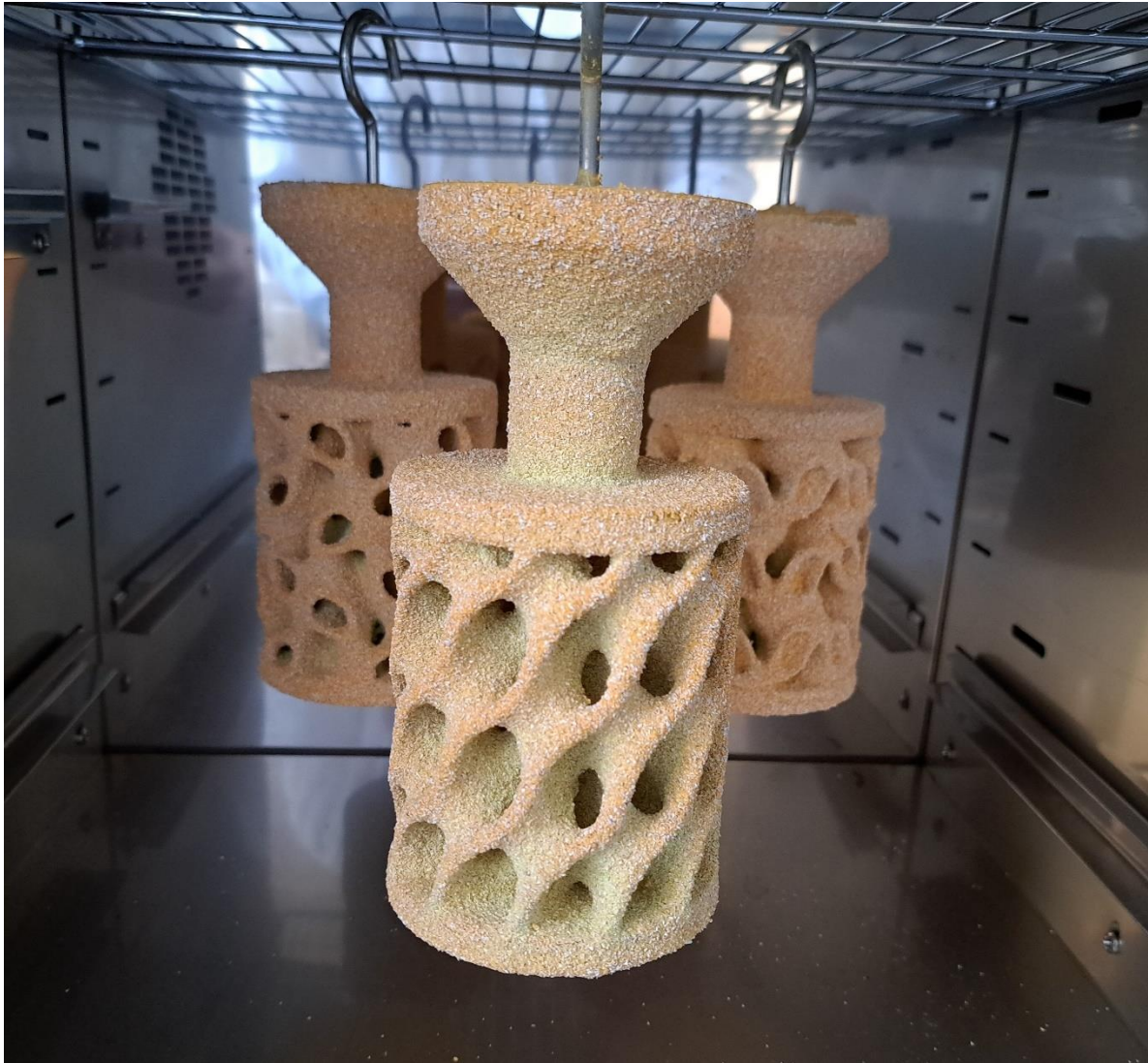
Slika 4.27. Sušenje keramičkih školjki na bazi koloidne silike
