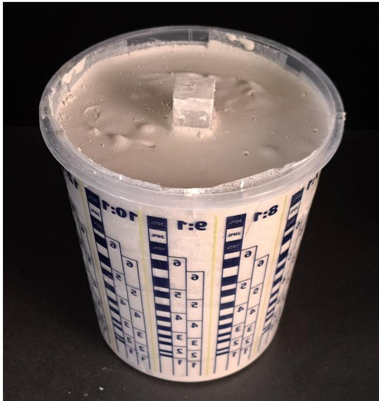
Slika 4.17. Gipsani kalup nakon inicijalnog stvrdnjavanja
