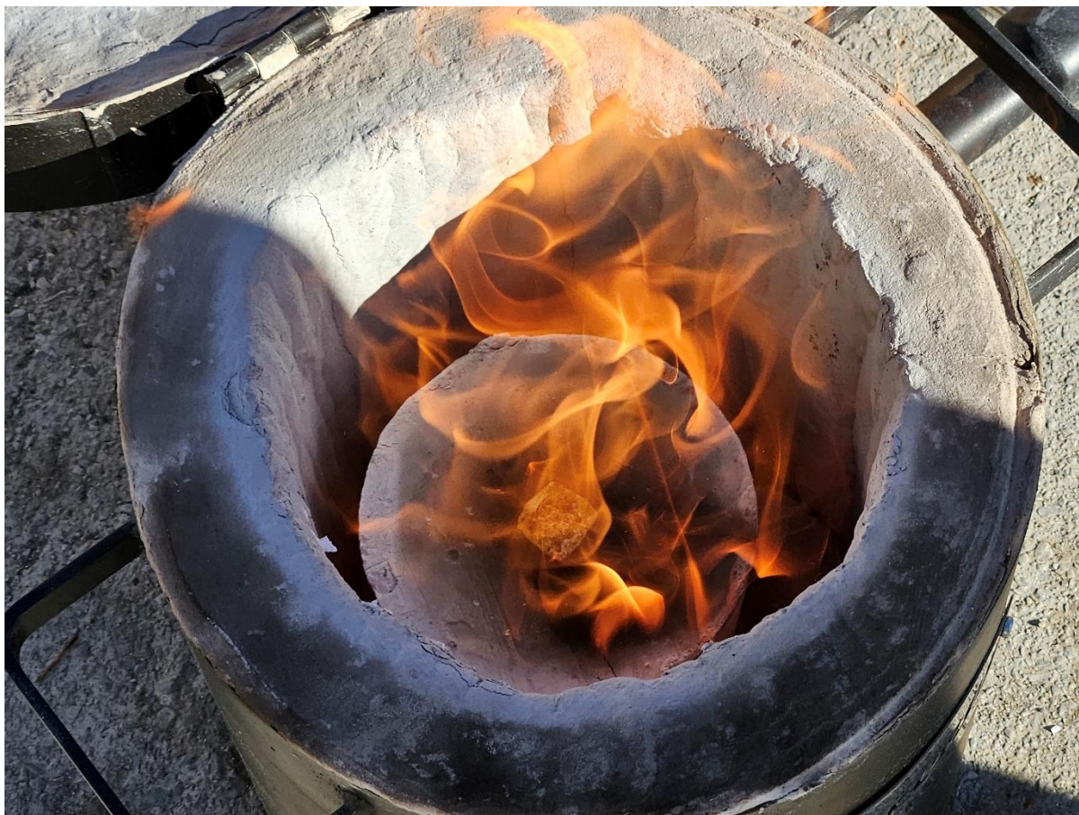
Slika 4.30. Izgaranje pramodela u gipsanom kalupu
