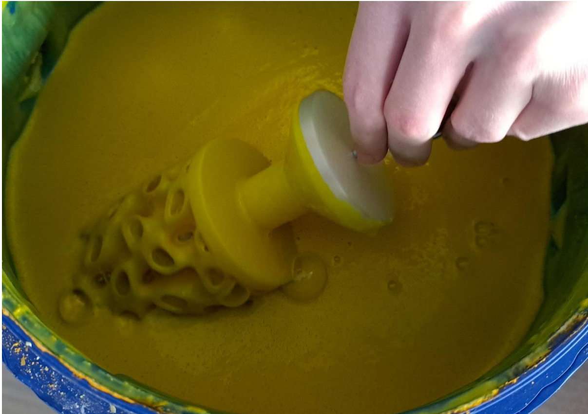
Slika 4.25. Uranjanje pramodela u keramičku suspenziju na bazi koloidne silike
