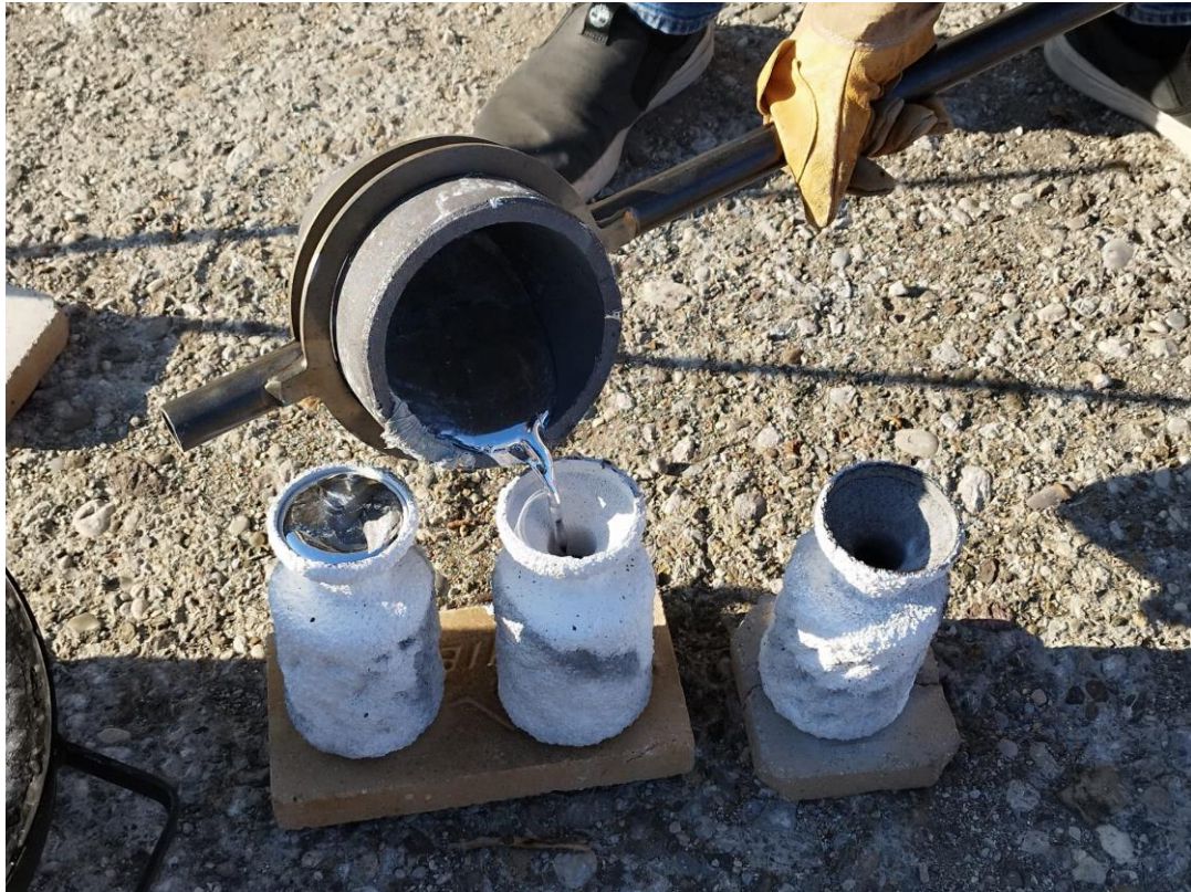
Slika 4.34. Lijevanje legure u keramičku školjku na bazi koloide silike
