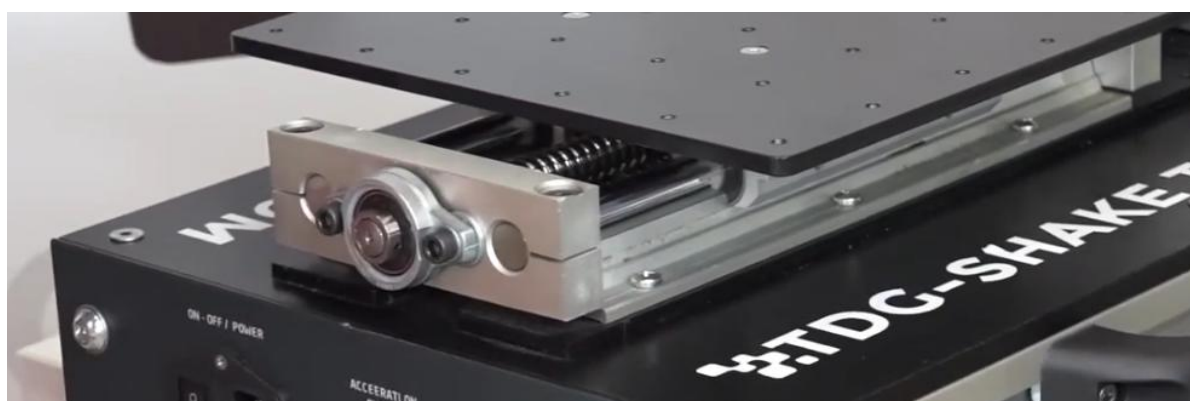
Slika 14. Izvedba pomicanja platforme ATOM, DTG [6.]
