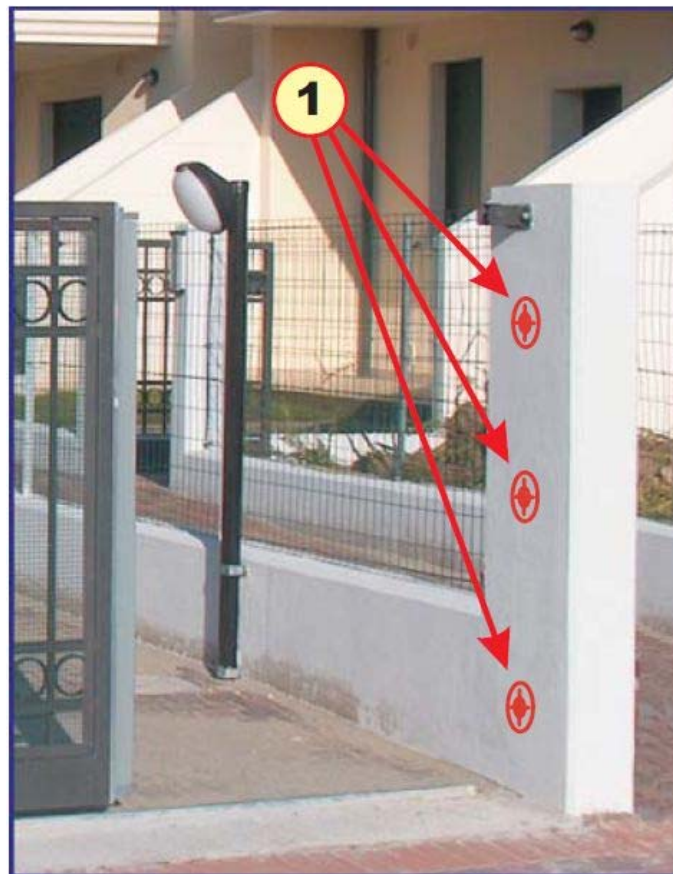
Slika 3.2. Položaj tri horizontalne točke u kojima je potrebno testirati udarne sile
