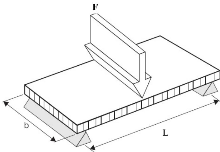
Slika 33. Skica savojnog opterećenja u tri točke
