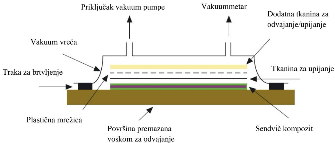
**Slika 21.** Vakuumiranje
