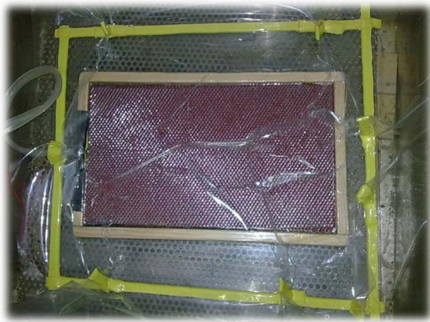
**Slika 22. Proces vakuumiranja sendvič kompozita**
