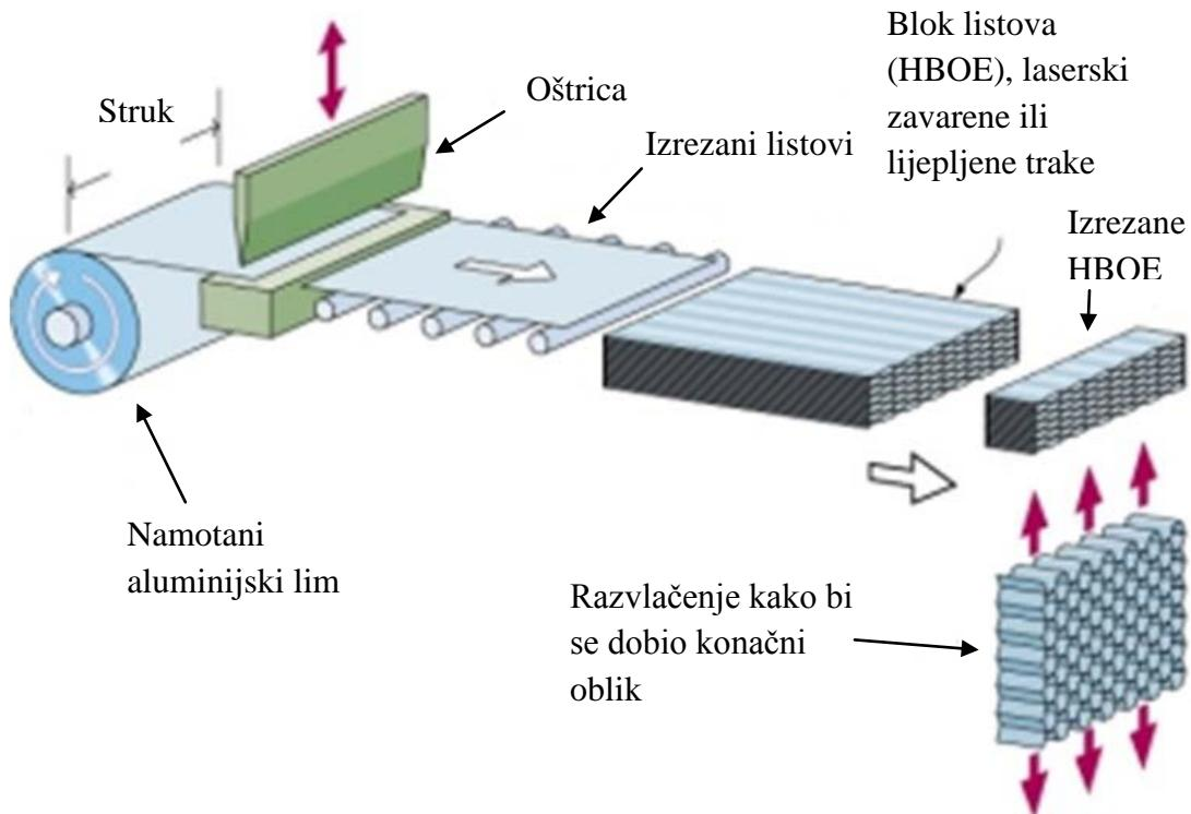
**Slika 4.** Shema postupka izrade saćaste šesterokutne jezgre prije ekspanzije (HOBE engl. Honeycomb before expansion) [9]
