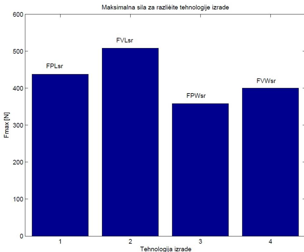
**Slika 42.** Prikaz srednjih vrijednosti maksimalnih sila F za različite tehnologije izrade uzoraka (1 – tlak i L orijentacija celija; 2 – vakuum i L orijentacija celija; 3 – tlak i W orijentacija celija; 4 – vakuum i W orijentacija celija)
