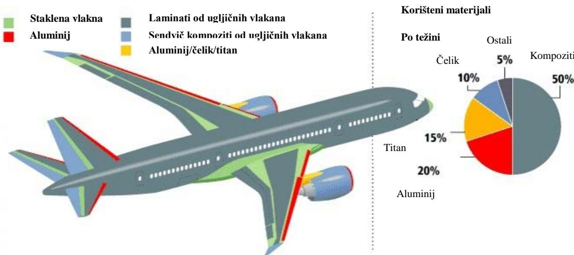
Slika 1. Primjena sendvič kompozita na zrakoplovu Boeing – 787 [1]
