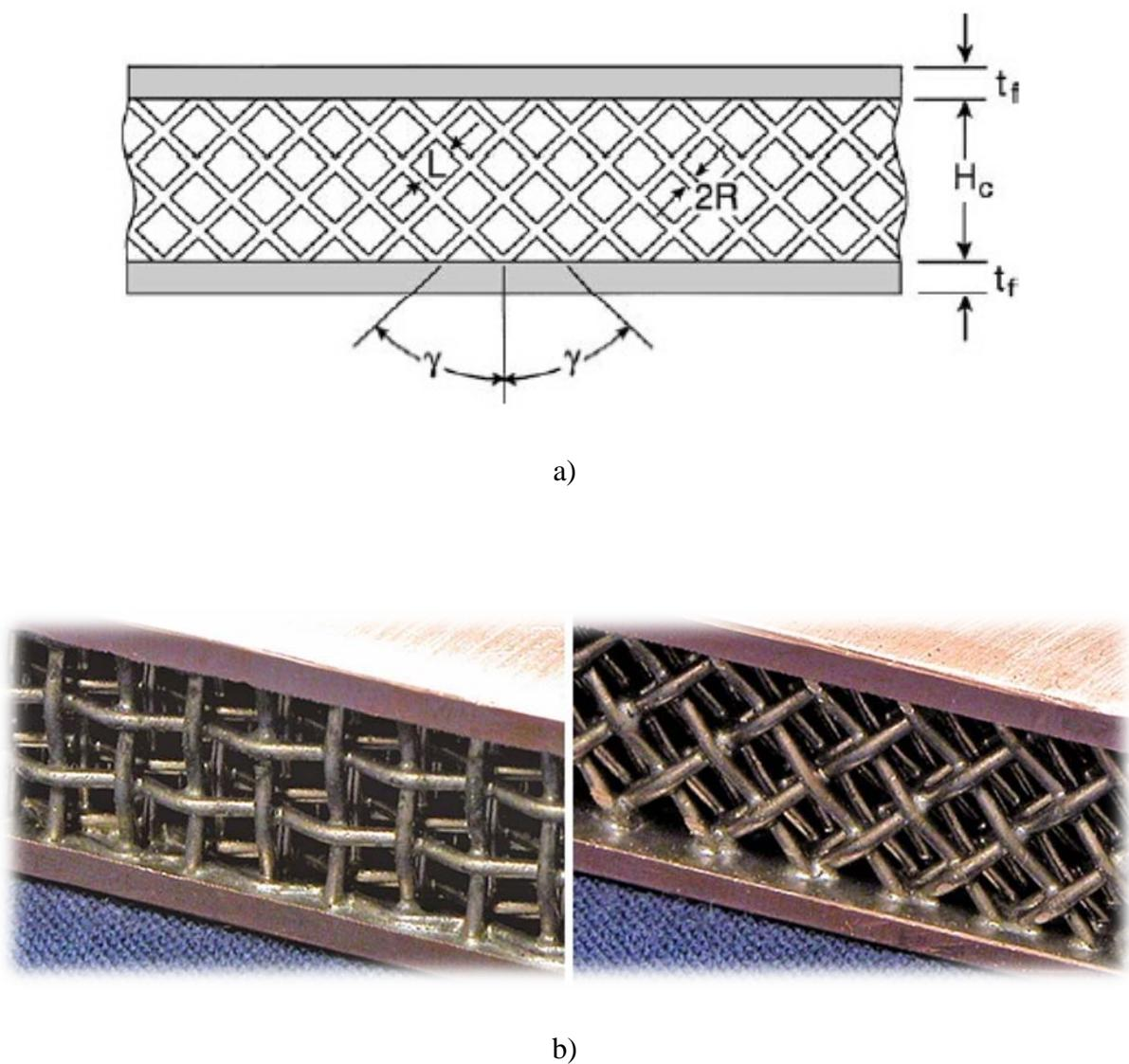
**Slika 9.a)** Shema sendvič kompozita od rešetkaste jezgre [12]; **b)** Izgled izmjenjivača topline od rešetkaste jezgre [9]
