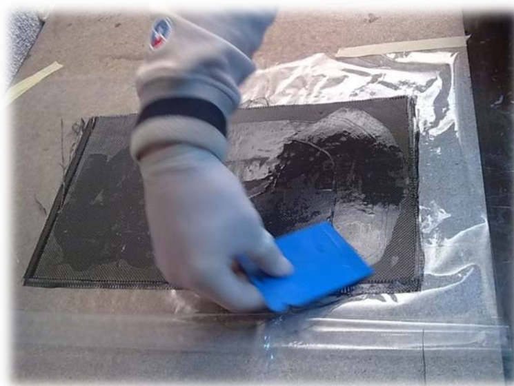
Slika 20. Izrada kora sendvič kompozita
