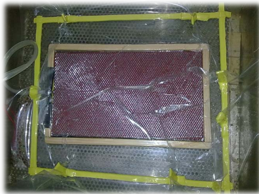
Slika 22. Proces vakuumiranja sendvič kompozita
