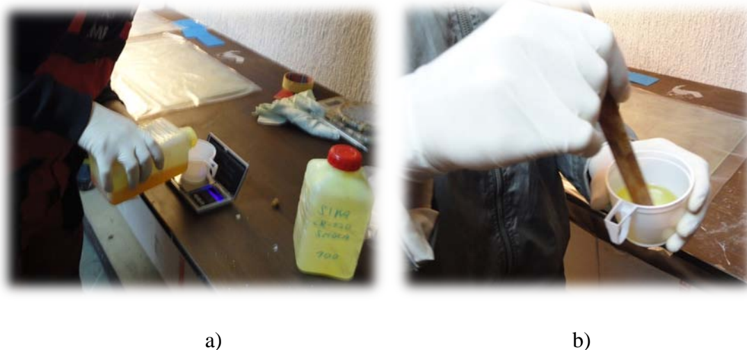
Slika 26. Priprema polimerne matrice : a) vaganje komponentata; b) miješanje komponentata
