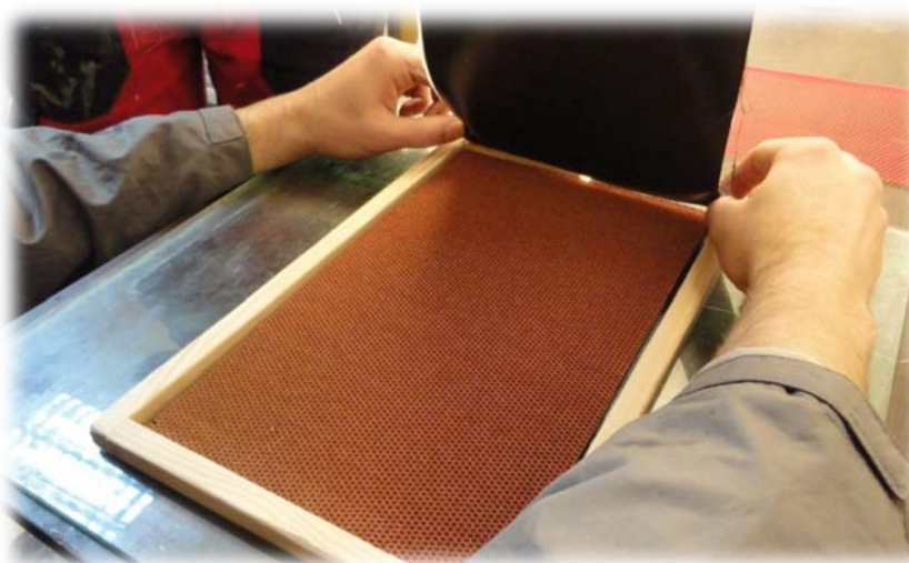
Slika 30. Postavljanje kora na jezgru
