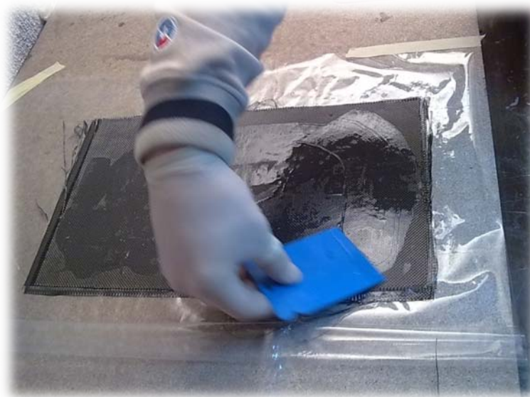
Slika 20. Izrada kora sendvič kompozita
