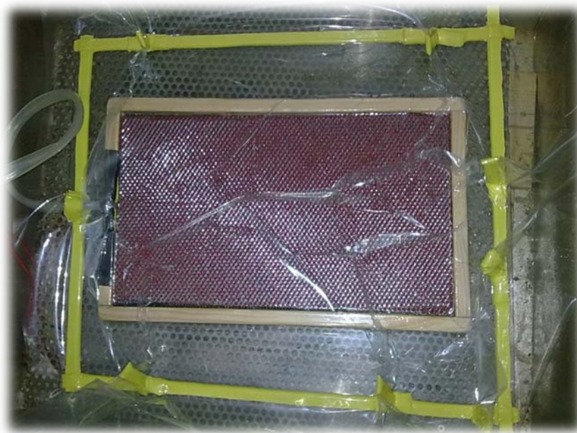
Slika 22. Proces vakuumiranja sendvič kompozita
