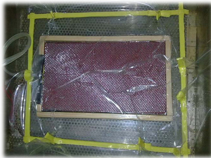
Slika 22. Proces vakuumiranja sendvič kompozita
