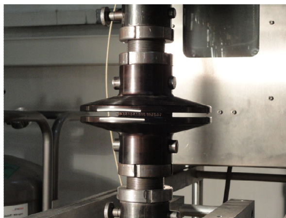
Slika 20. Tlačno opterećen uzorak
