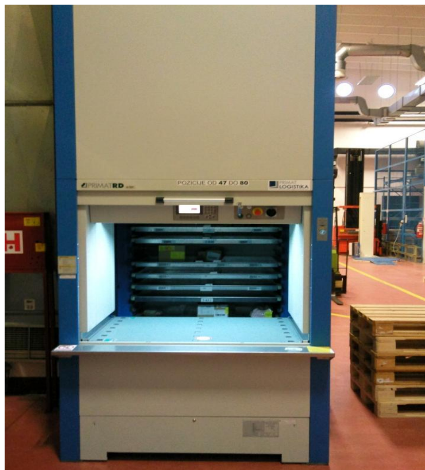
Slika 14. Vertikalni podizni modul – Shuttle 1.
