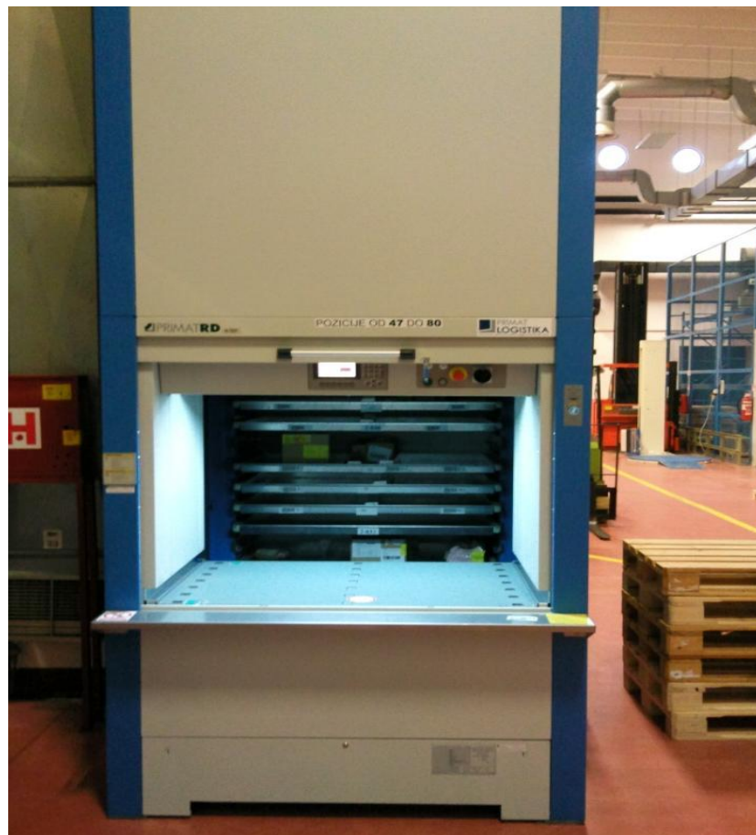
Slika 14. Vertikalni podizni modul – Shuttle 1.
