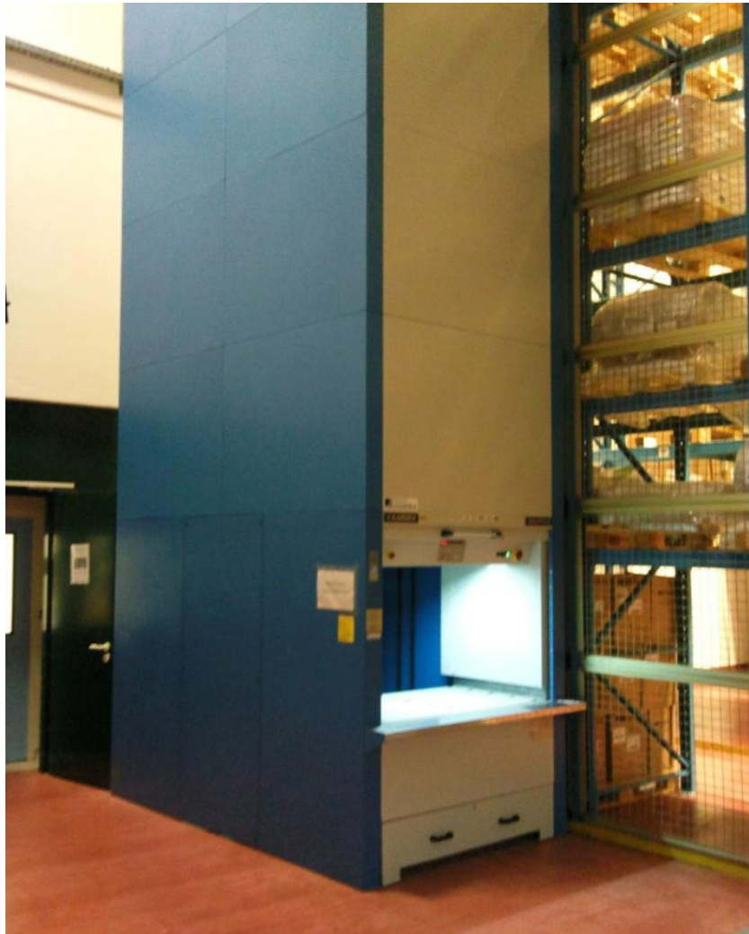
Slika 15. Vertikalni podizni modul – Shuttle 2
