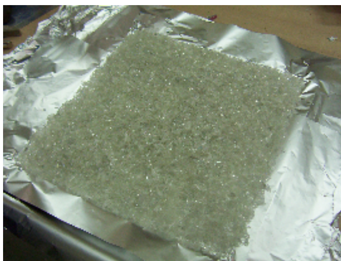
Slika 5.4. Aluminijska folija u kalupu
