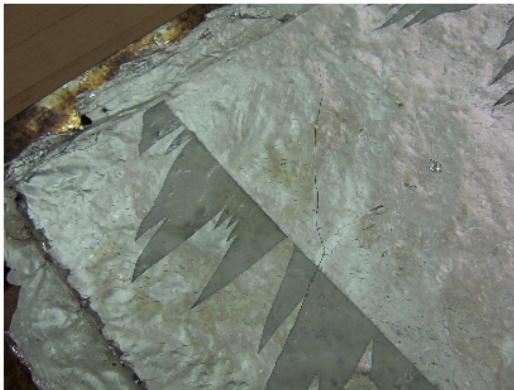
Slika 5.7. Otpresak hlađen vodom
