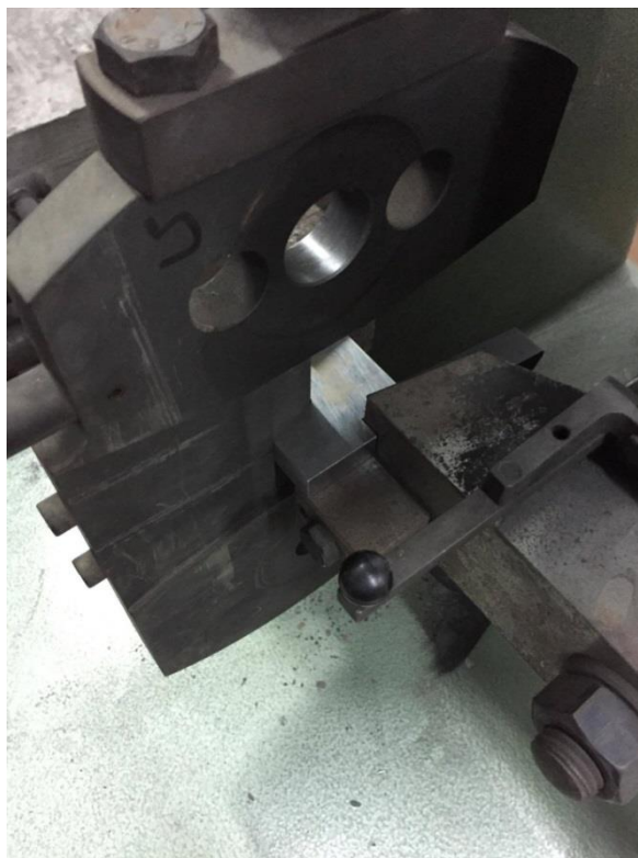
Slika 4.17 Kut klatno epruveta određen pomoću indigo papira
