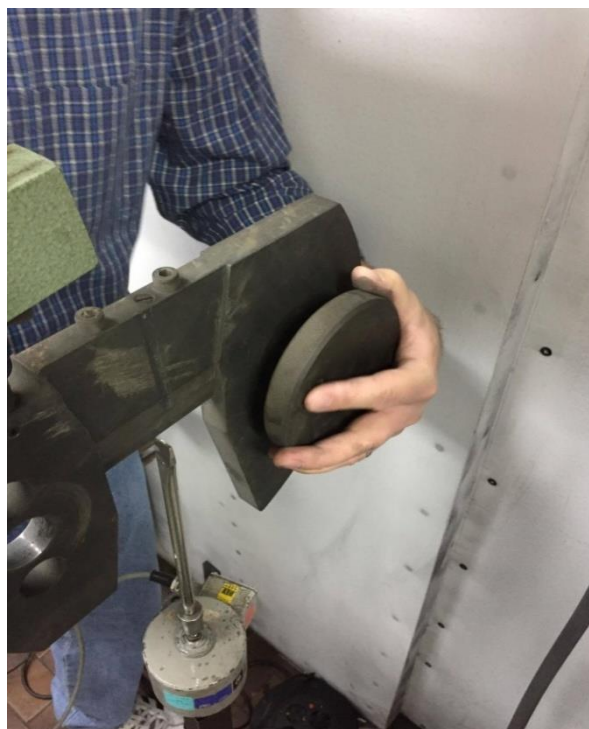
Slika 4.18 Masa bata sa utezima određena s dinamometrom
