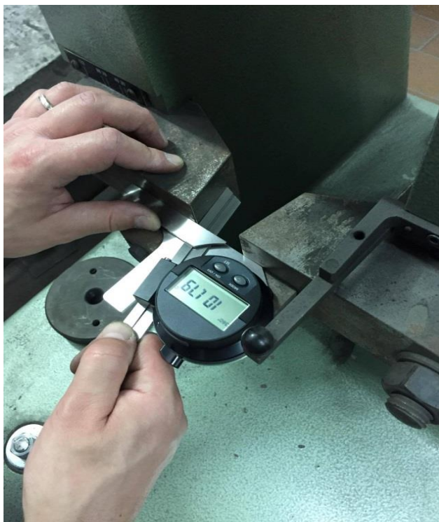
Slika 4.10 Mjerenje kuta podupirača digitalnim kutomjerom
