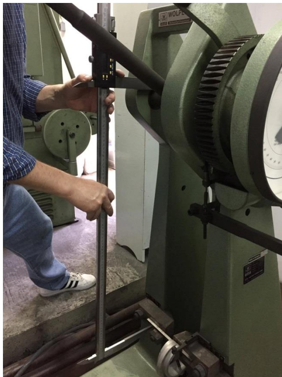
Slika 4.15 Duljina klatna mjerena velikim pomičnim mjerilom od sredine osovine do središta epruvete
