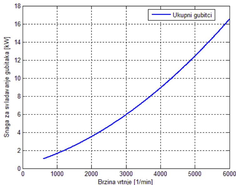
Slika 6.6. Snaga potrebna za svladavanje mehaničkih gubitaka.
