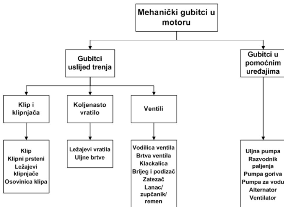
Slika 2.1. Izvori mehaničkih gubitaka u motoru [2].
