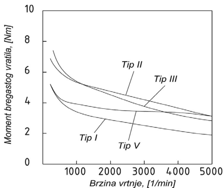
Slika 2.9. Moment za pokretanje različitih vrsta razvodnih mehanizama prikazanih na slici 2.8. (TIP II je izведен bez kotačića ) ovisno o brzini vrtnje motora [2].
