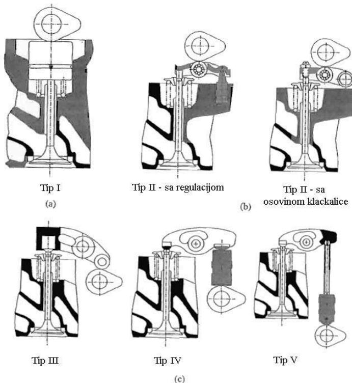
Slika 2.8. Vrste razvodnih mehanizama. (a) direktno djelovanje, (b) djelovanje pomoći poluklackalica, (c) djelovanje pomoći klackalica i podizača(Tip IV i V)
