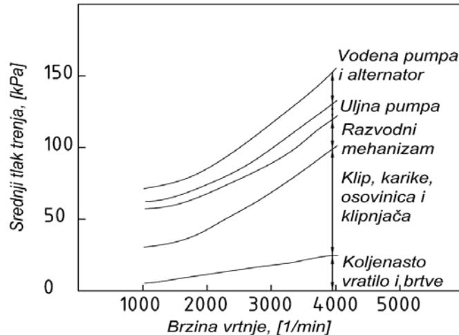
Slika 2.2. Udjeli mehaničkih gubitaka pojedinih komponenti četverocilindarskog Otto motora prikazan pomoću srednjeg tlaka trenja ovisnosti o brzini vrtnje motora [1].
