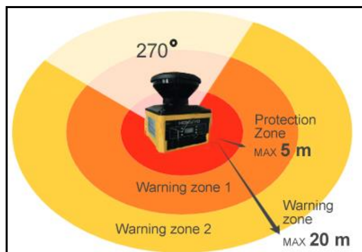
Slika 17. Sigurnosna polja senzora Hokuyo UAM [26]
