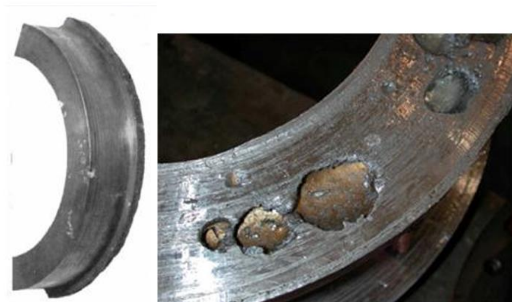
Slika 1. Plinska poroznost u odljevku [8]
