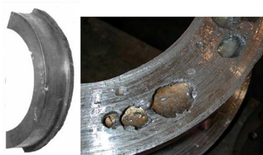
Slika 1. Plinska poroznost u odljevku [8]
