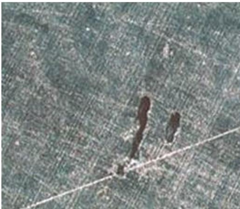
Slika 2. Poroznost skupljanja u odljevku [8]
