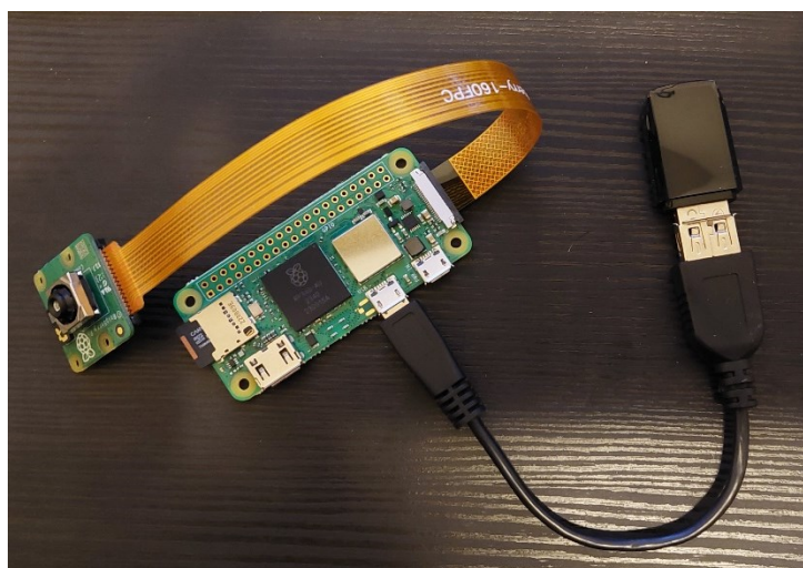
Slika 26. Raspberry Pi povezan s kamerom i Wi-Fi adapterom
