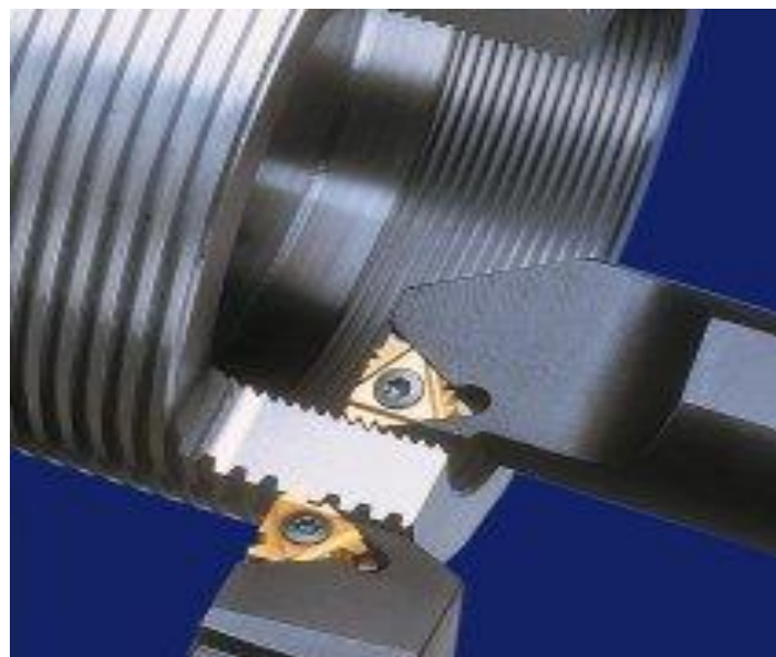
Slika 11. Tokarenje unutarnjeg i vanjskog navoja [7]
