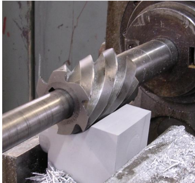
Slika 23. Obodno ravno glodanje-istosmjerno [6]
