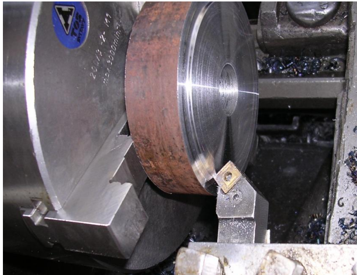
Slika 10. Poprečno (plansko) tokarenje [3]
