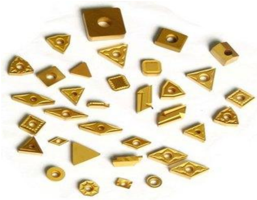
Slika 18. Vrste i oblici pločica za tokarenje [9]
