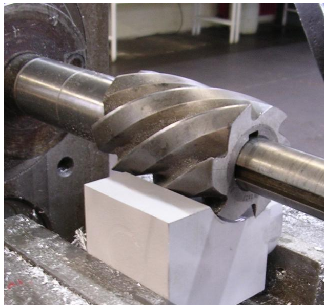
Slika 24. Obodno ravno glodanje-protusmjerno [6]
