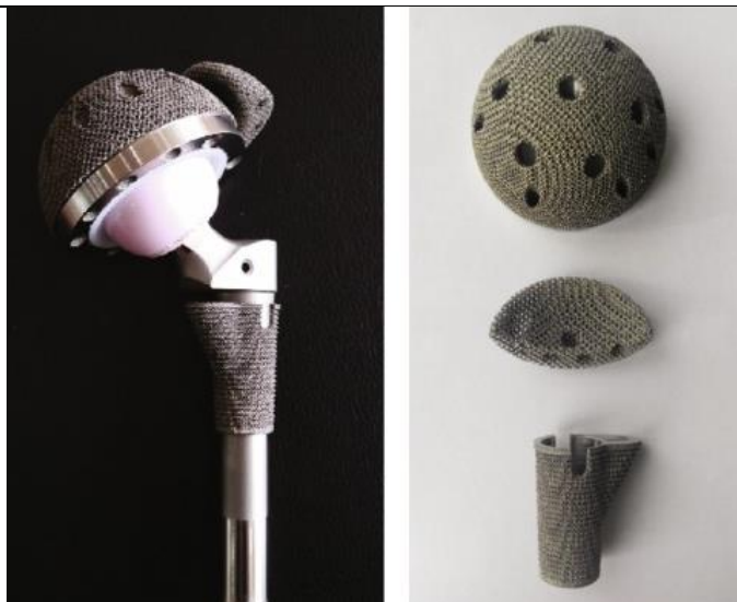
Slika 5. Sklop i dijelovi implantata kuka od legure Ti6Al4V [9]
