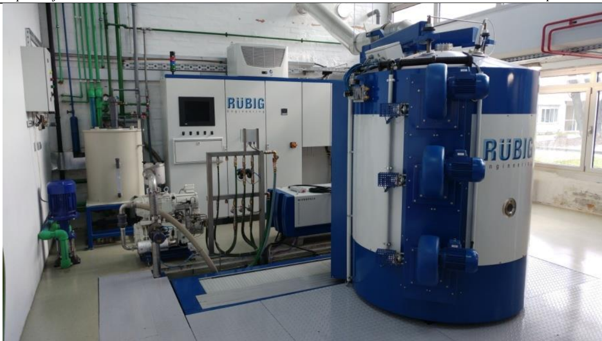
Slika 21. Prikaz vakumske peći PC 70/90 za prevlačenje PACVD postupkom
