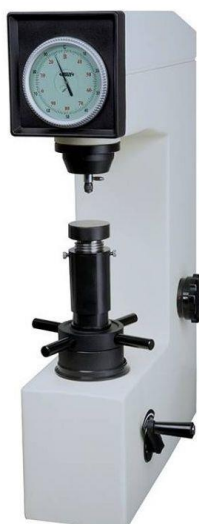
Slika 28. Tvrdomjer Insize za ispitivanje adhezivnosti [26]
