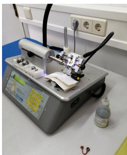
Slika 26. Uređaj Tribotechnic calotester za određivanje debljine prevlake
