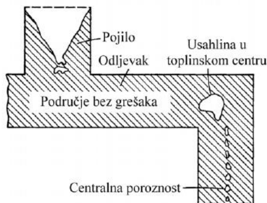
Slika 33. Nastanak poroznosti u odljercima lijevanim od legura sa uskim intervalom skrućivanja [6]
