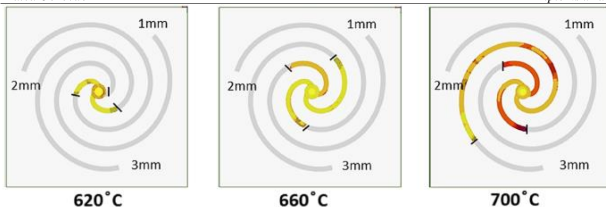
Slika 12. Utjecaj temperature lijevanja na tečljivost [7]
