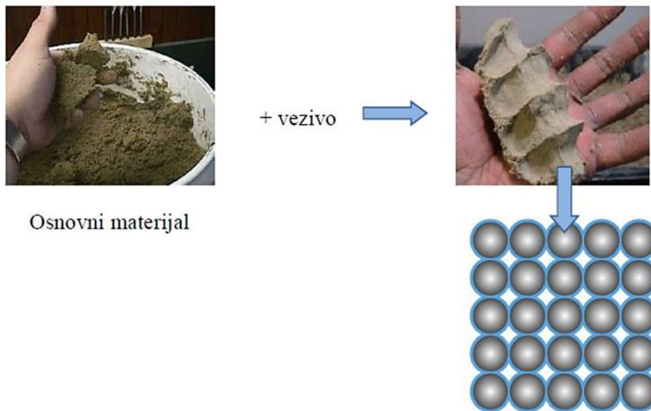
Slika 36. Povezivanje zrnaca pijeska dodatkom veziva [1]
