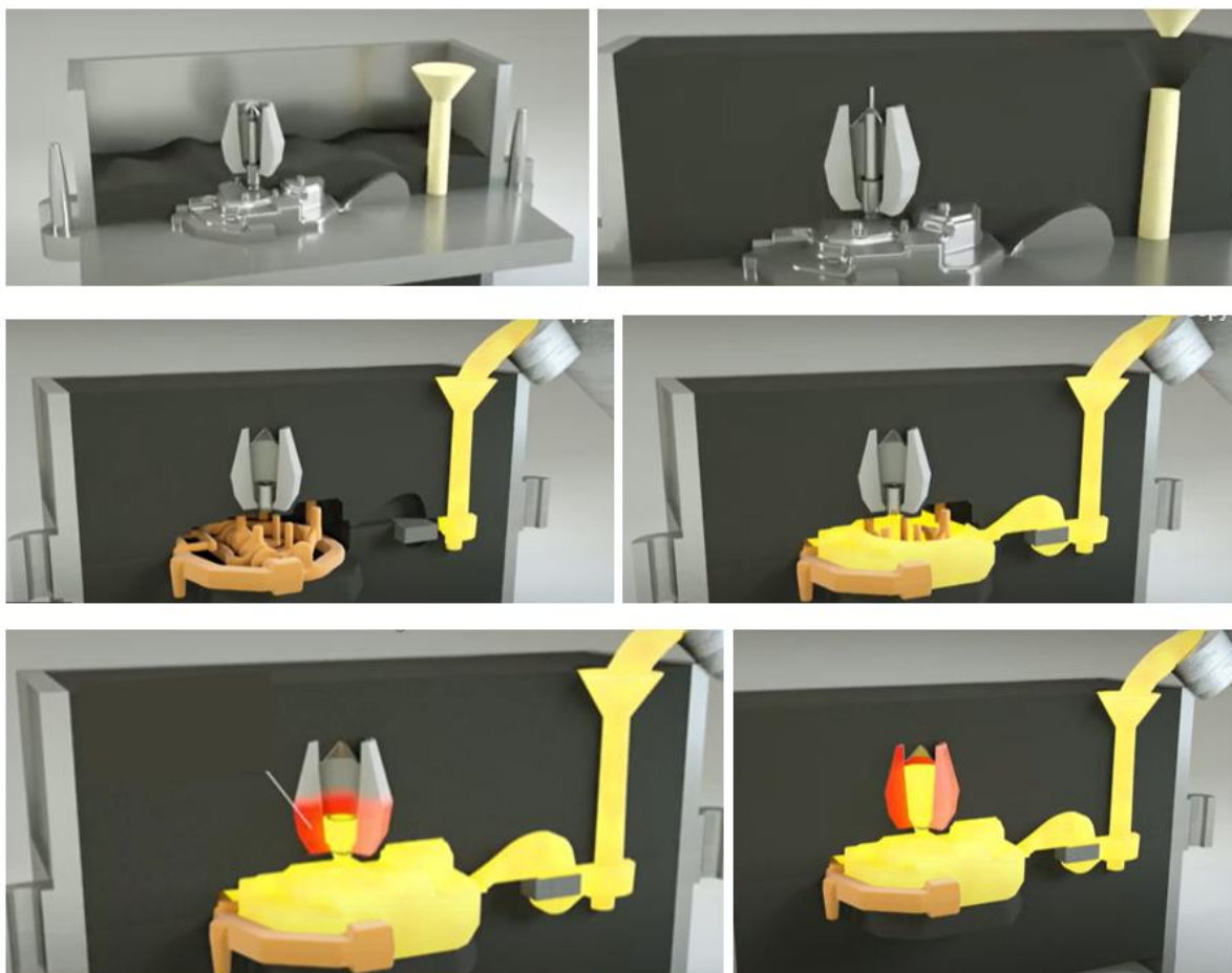
Slika 34. Proces lijevanja pri korištenju egzotermne obloge tvrtke ASK Chemicals [12]
