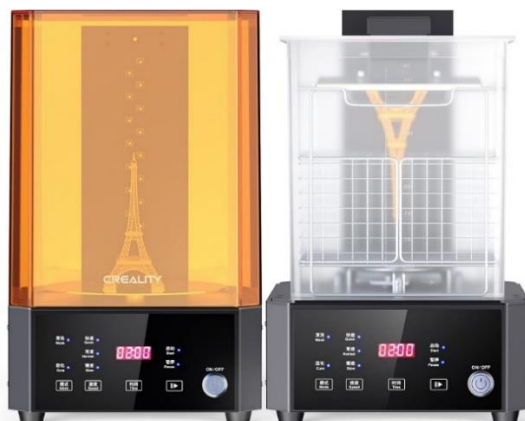
Slika 6. Uređaji za ispiranje i očvršćivanje [10]
