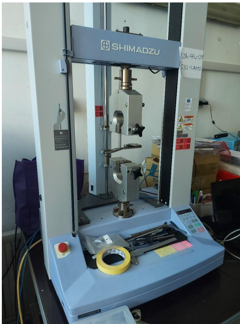
Slika 26. Kidalica Shimadzu AGS-X (10 kN)
