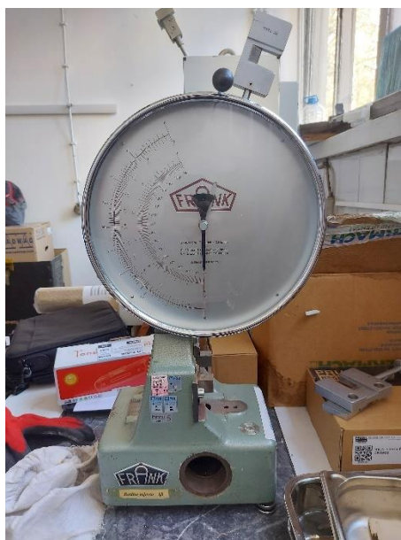
Slika 31. Uređaj marke Frank za ispitivanje žilavosti
