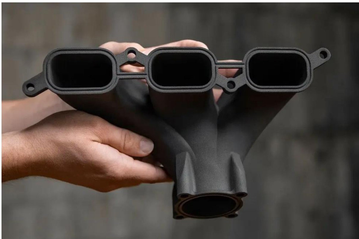
Slika 8. Prikaz proizvoda načinjenog SLS postupkom [12]
