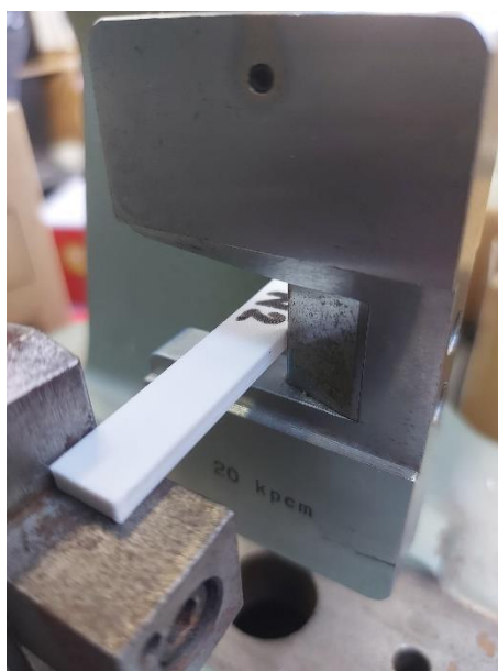
Slika 32. Prikaz korištenog bata i položaj ispitnog tijela
