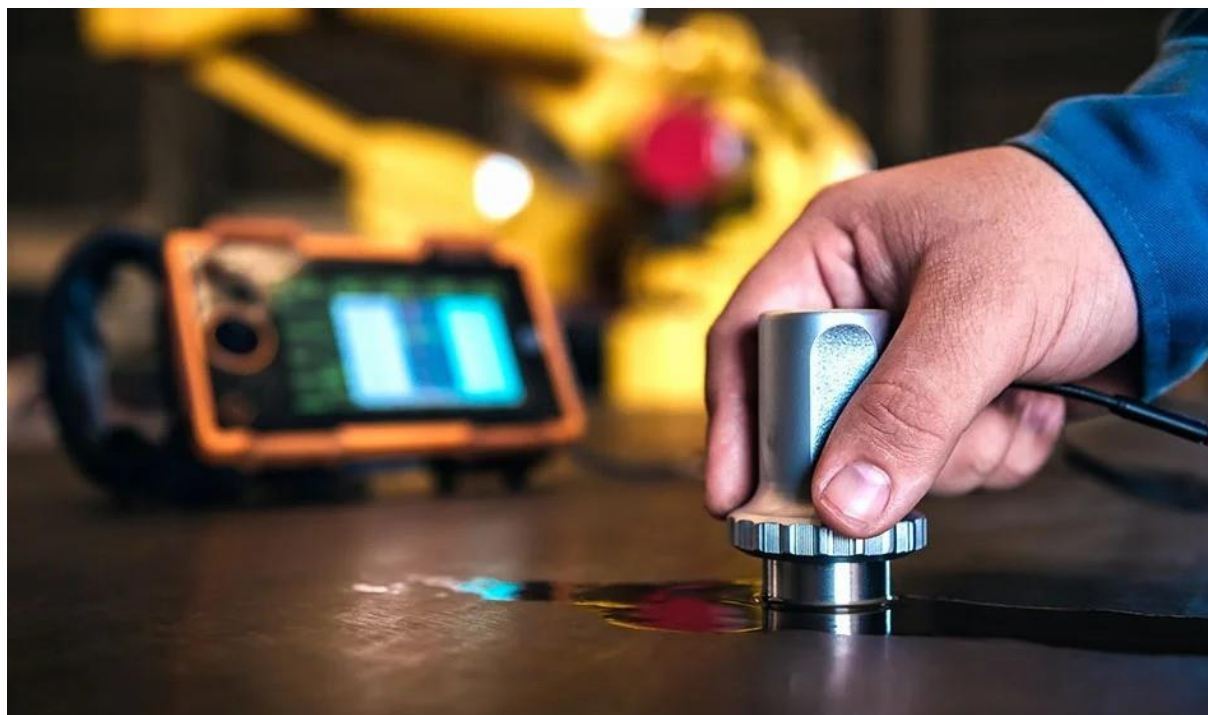
Slika 4. Nerazorno ispitivanje materijala ultrazvukom [3]
