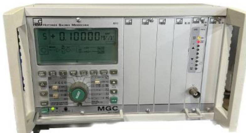
Slika 29. Mjerno pojačalo HBM AB12 [34]
