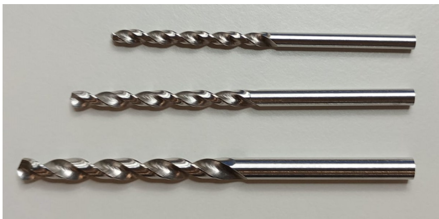
Slika 41. Industrijska svrdla s vršnim kutom od 130^\circ i kutom uspona žlijeba od 30^\circ
