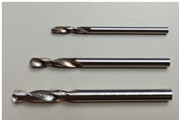
Slika 38. Industrijska svrdla s vršnim kutom od 130^\circ i kutom uspona žlijeba od 25^\circ
