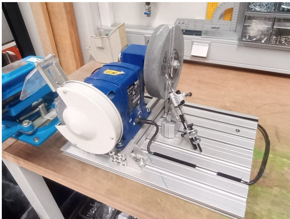
Slika 45. Postav za oštrenje medicinskih svrdala
