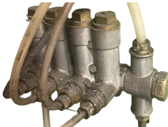
Slika 14: Set dozirnih ventila za podmazivanje kliznih staza Y osi i matice kugličnog vretena Y osi
