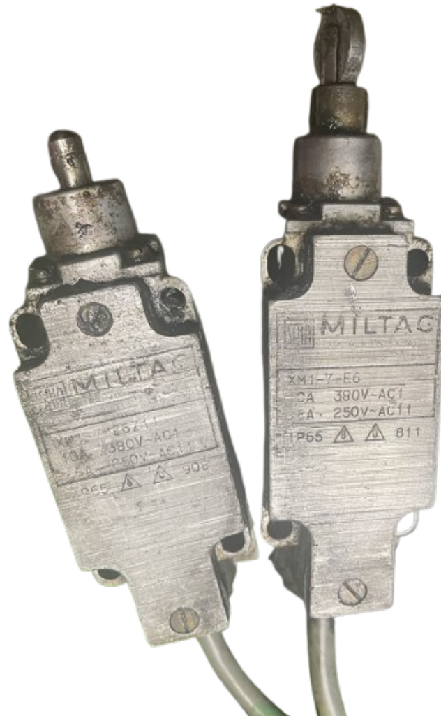
Slika 7: Granični prekidač s dva stanja (lijevo) i kombinacija graničnog i referentnog prekidača s tri stanja (desno)
