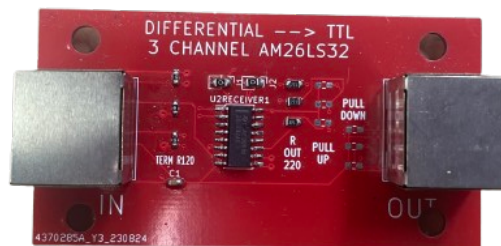
Slika 29: Pretvornik diferencijalnih signala u jednostruke signale s tri kanala
