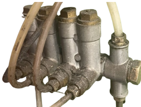
Slika 14: Set dozirnih ventila za podmazivanje kliznih staza Y osi i matice kugličnog vretena Y osi
