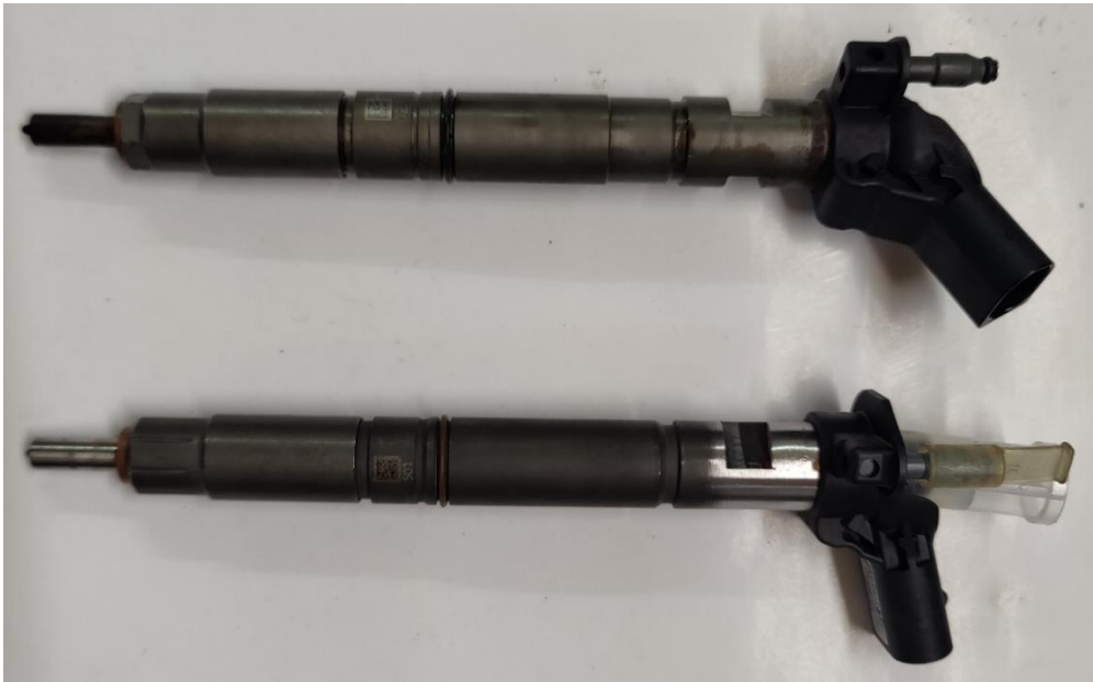
Slika 33. Primjer originalne i protočnije visokotlačne brizgaljke
