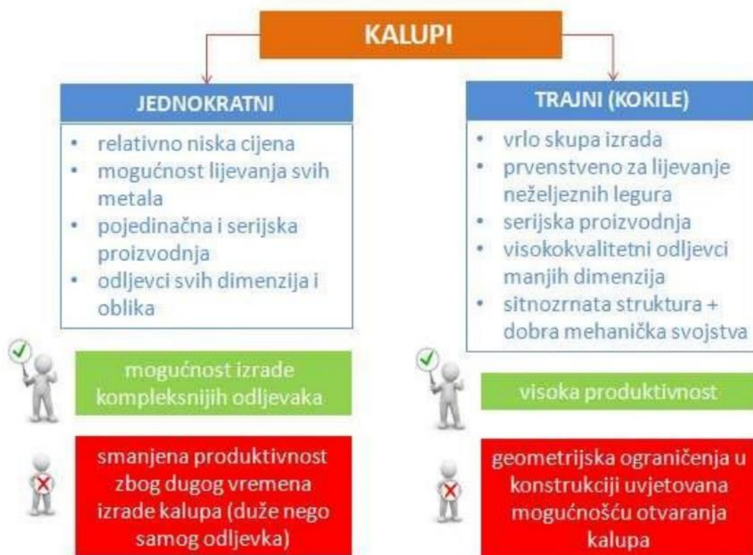
Slika 4. Osnovne značajke jednokratnih i trajnih kalupa [3]
