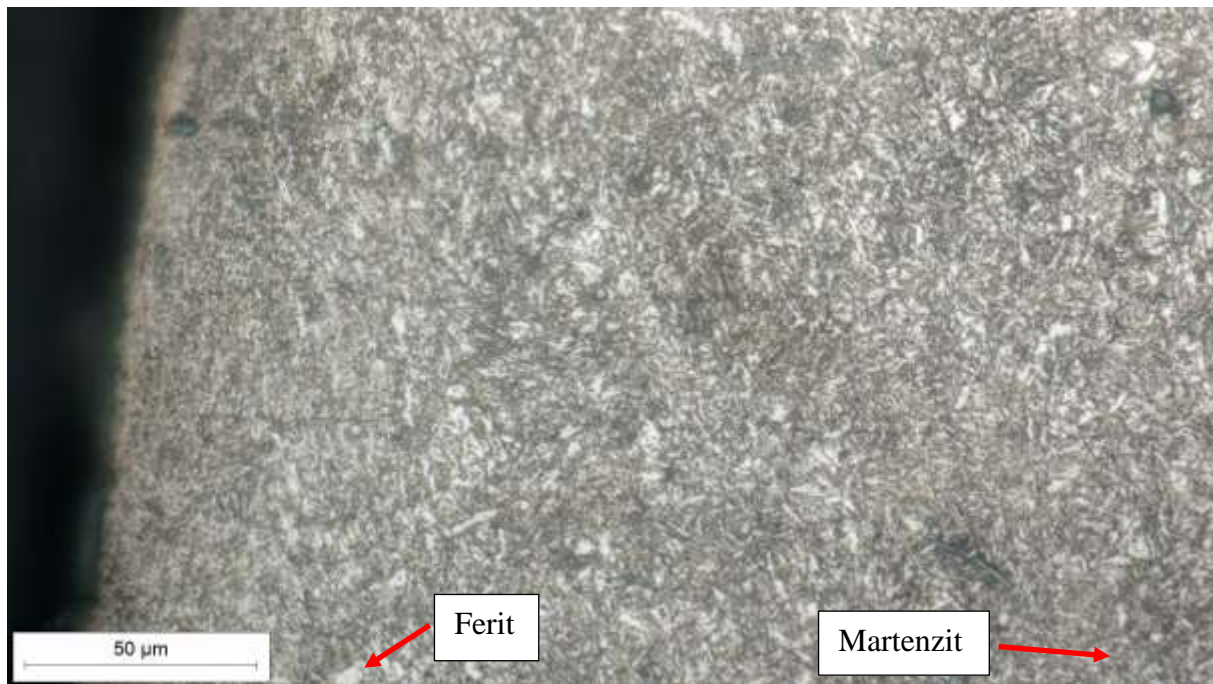
Slika 25. Mikrostruktura zuba pogonskog zupčanika, povećanje 500x
