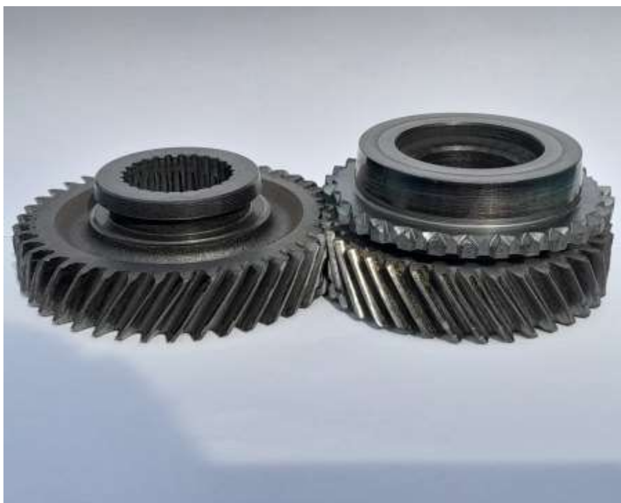
Slika 18. Zupčanici nakon čišćenja i odmašćivanja
