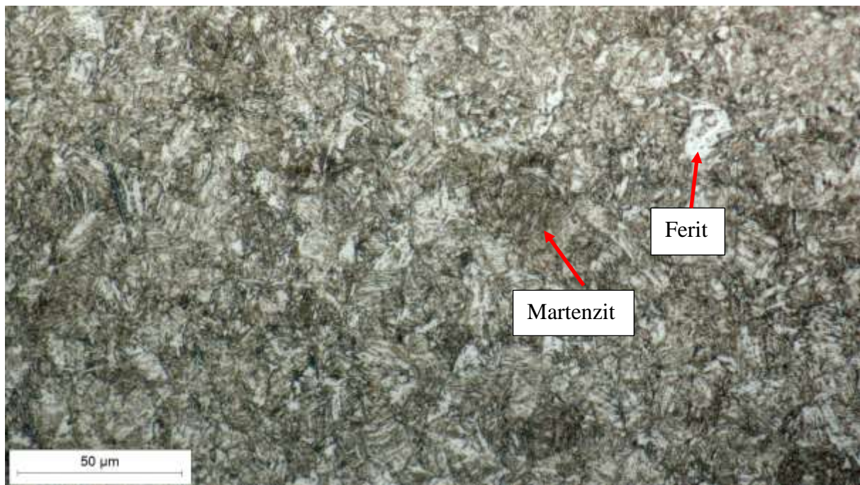
Slika 26. Mikrostruktura središnjeg dijela pogonskog zupčanika, povećanje 500x
