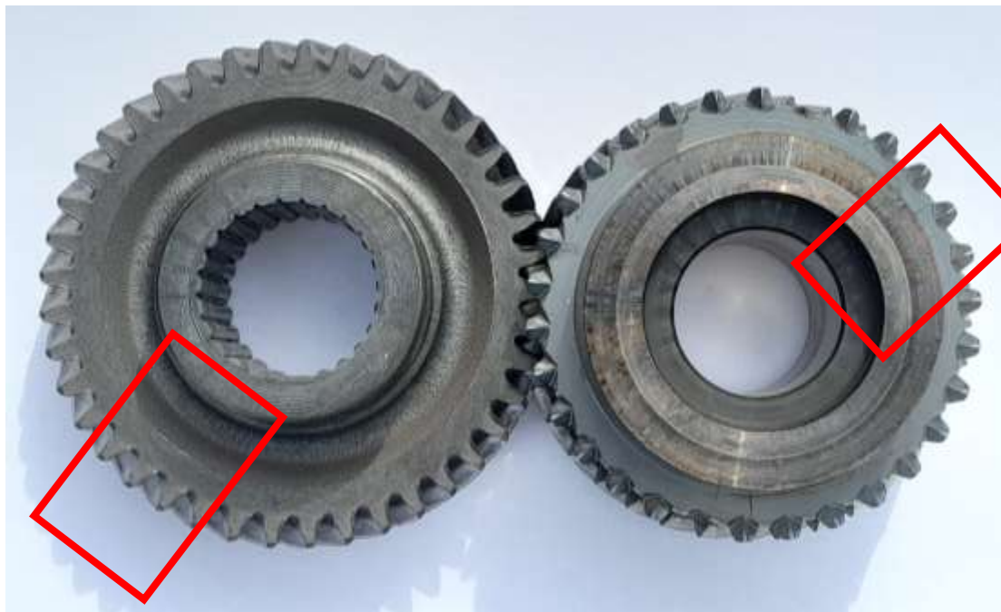
Slika 19. Označeni dijelovi zupčanika koji su izrezani
