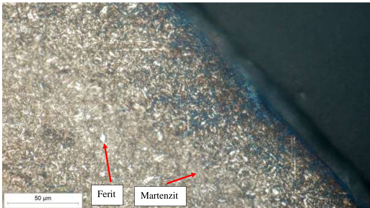
Slika 23. Mikrostruktura zuba gonjenog zupčanika, povećanje 500x
