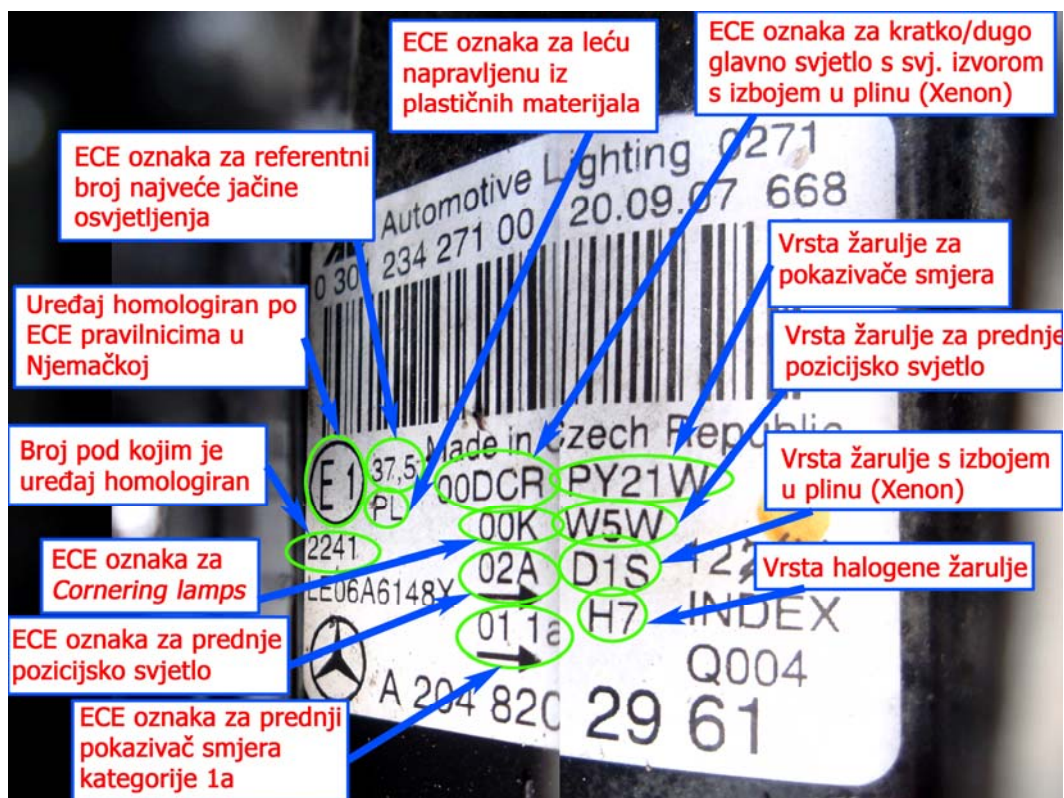
Slika 40. Oznake na naljepnici glavnog svjetlosnog sklopa vozila Mercedes C300 uvezenom iz EU
