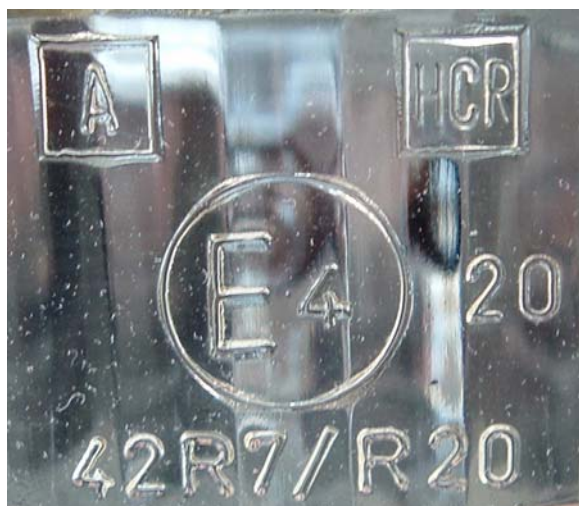
Slika 5. Primjer oznake po ECE standardu na glavnom svjetlu
