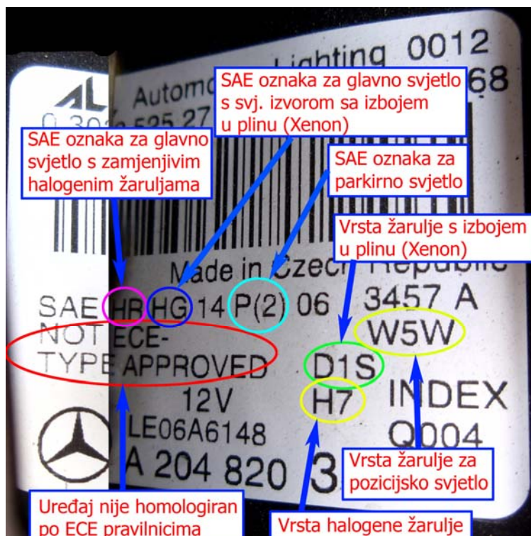
Slika 39. Oznake na naljepnici glavnog svjetlosnog sklopa vozila Mercedes C300 uvezenog iz SAD-a
