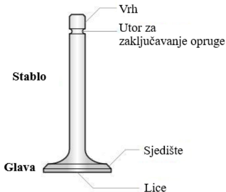
Slika 1. Glavni dijelovi tanjurastog ventila [5]
