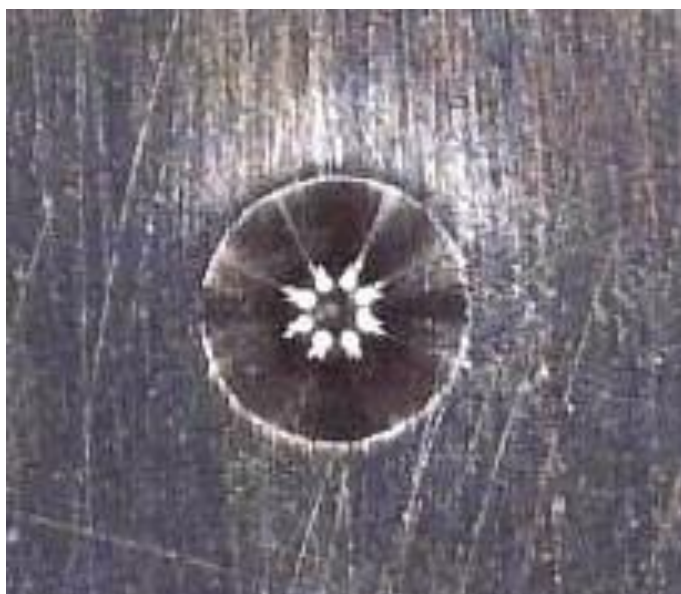
Slika 27. Otisak indentora na uzorku B1
