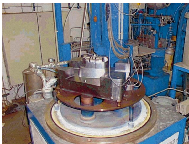
Slika 10. Polovica kalupa prevučena prevlakom TiCN-a [16]
