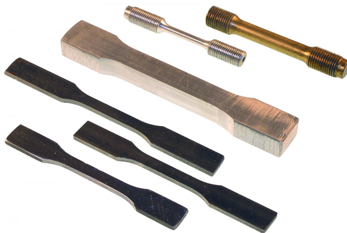
Slika 9: Ispitni uzorci pripremljeni za jednoosni vlačni test [13]
