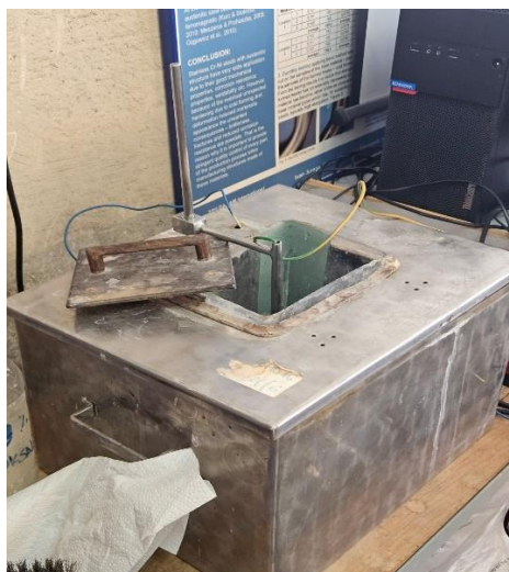
Slika 16. Uređaj za elektrokemijsko nagrizanje
