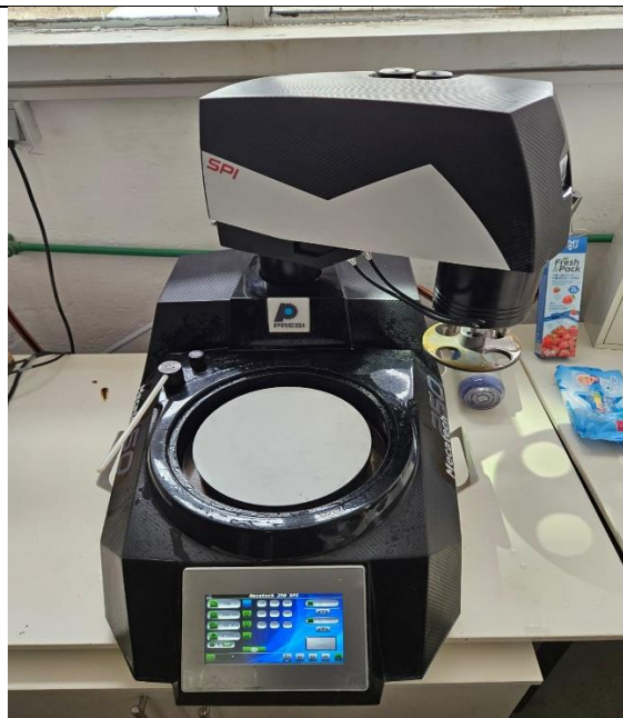
Slika 15. Uređaj za brušenje Mecatech 250 SPI
