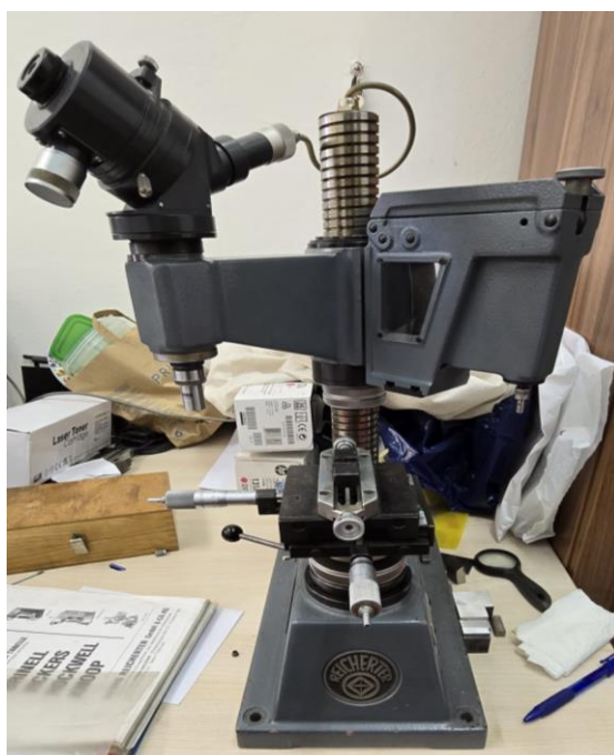
Slika 18. Uređaj Reichert za mjerenje mikrotvrdoće
