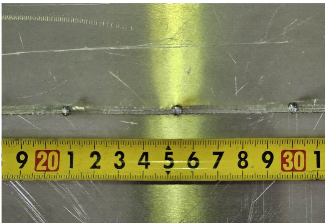
Slika 35. Uzorak 1 korijen zavara
