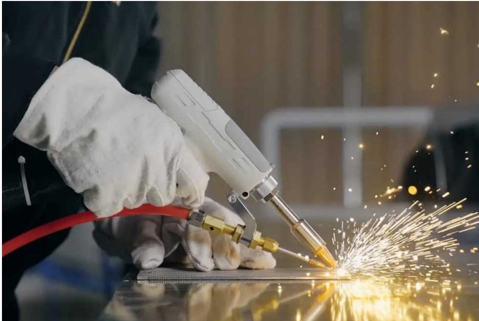
Slika 18. Zavarivanje laserom uz dodavanje dodatnog materijala [15]
