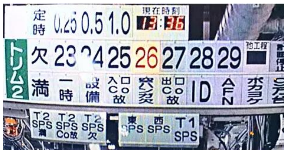
Slika 20. Andon ploča u Toyotinom proizvodnom pogonu
