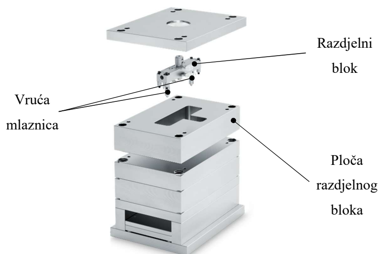
Slika 16. Kućište kalupa s vrućim uljavnim sustavom [9]
