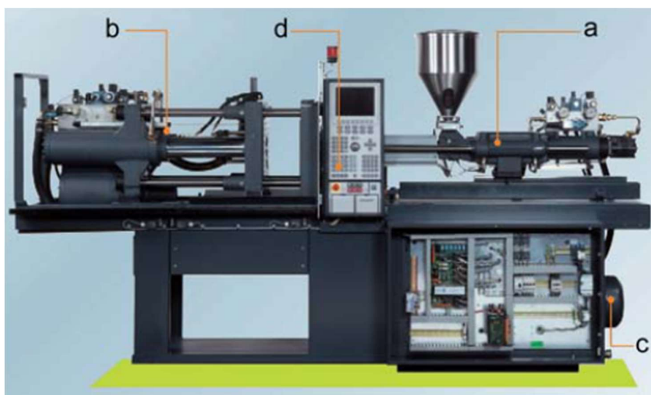
Slika 3. Ubrizgavalica – na slici: a - jedinica za ubrizgavanje, b - jedinica za otvaranje i zatvaranje kalupa, c – pogonska jedinica, d – upravljačka jedinica [4]
