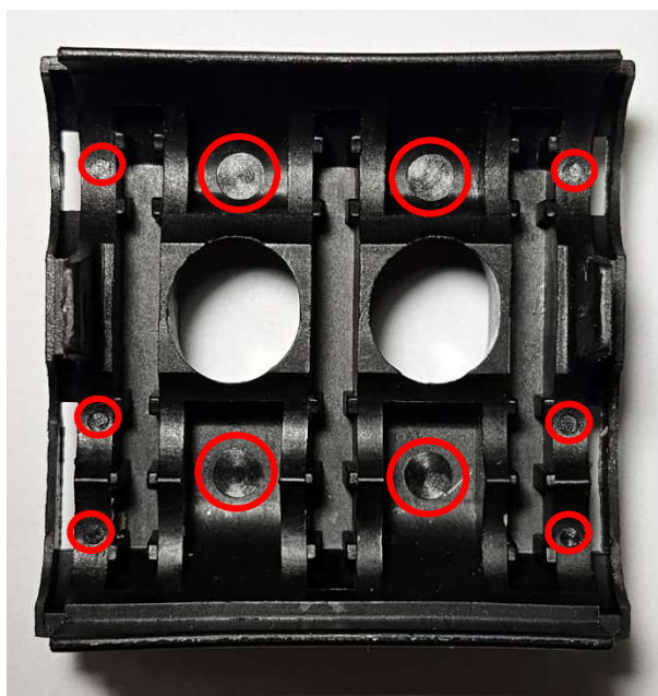
Slika 67. Otisci izbacivala na otpresku gornjeg dijela kućišta ZOS 3/2 stezaljke
