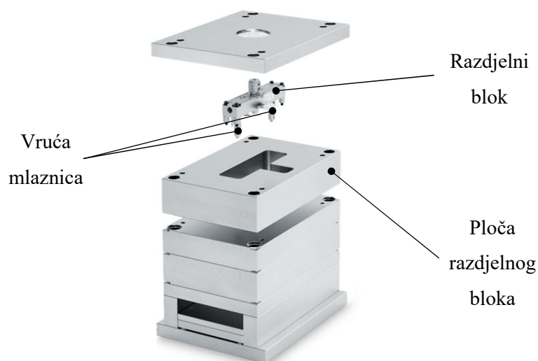
Slika 16. Kućište kalupa s vrućim uljavnim sustavom [9]
