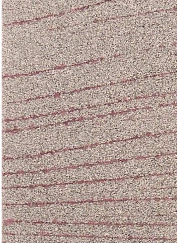
Slika 31. Indikacije na uzorku uz čišćenje tekućom vodom
