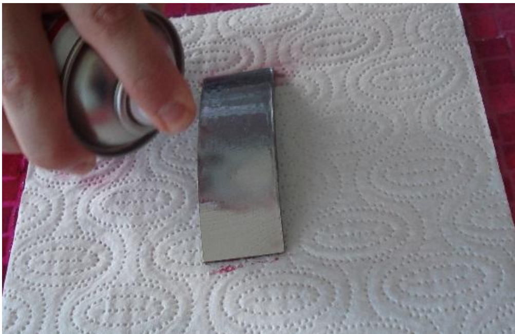
Slika 29. Nanašanje sredstva za čišćenje s male udaljenosti
