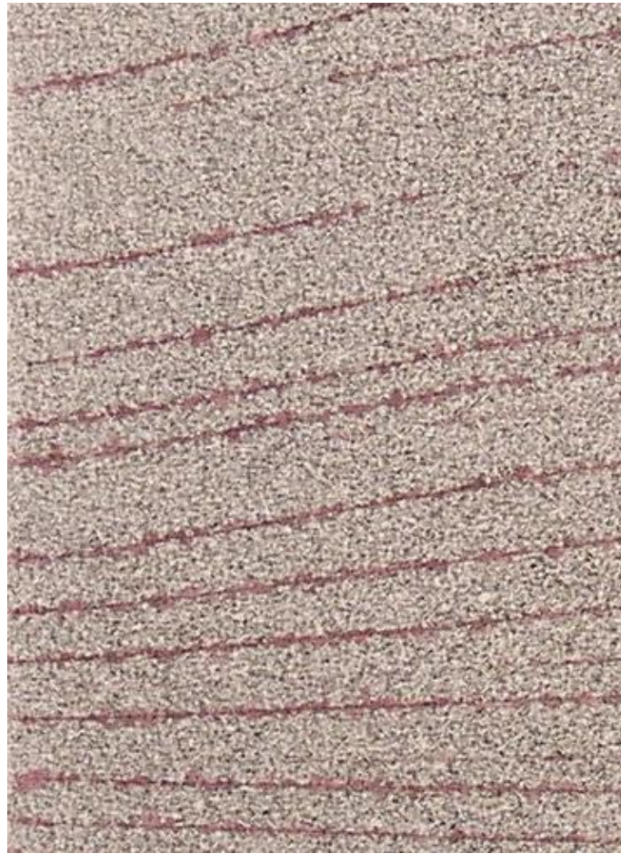
Slika 31. Indikacije na uzorku uz čišćenje tekućom vodom
