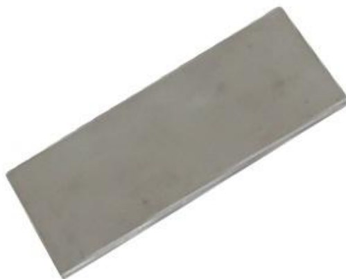
Slika 12. Izgled uzorka za ispitivanje sposobnosti ispiranja od nehrđajućeg čelika [16]
