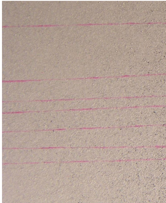
Slika 37. Uzorak Tipa 1 prema EN ISO 3452-3 [11] nakon 4min razvijanja
