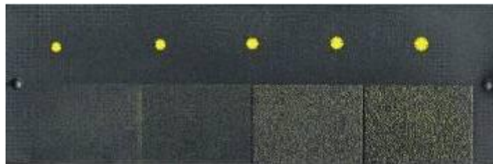
Slika 8. Izgled pločice Tipa 2 prema EN ISO 3452-3 [11] (žute zvjezdice predstavljaju pukotine) [13]
