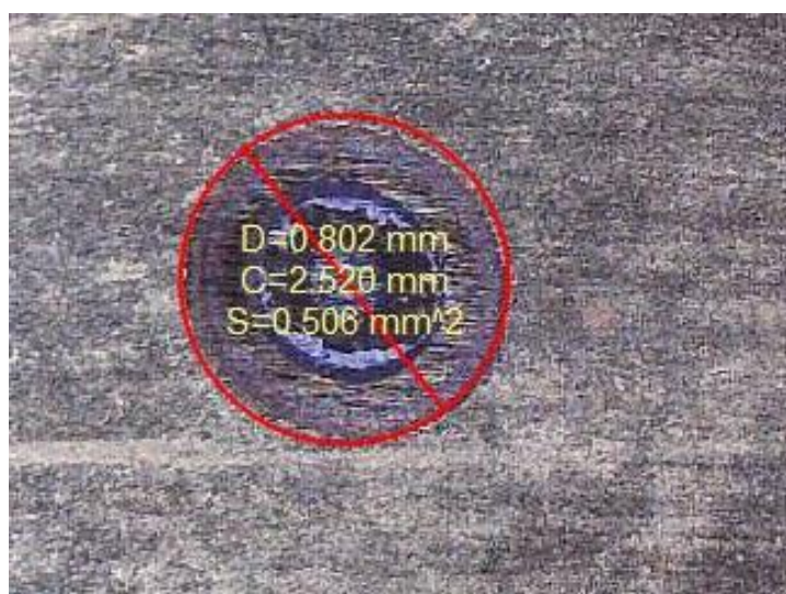
Slika 28. Slika 27. Ispitivanje kalotestom na TiN prevlaci nastalom PACVD postupkom
