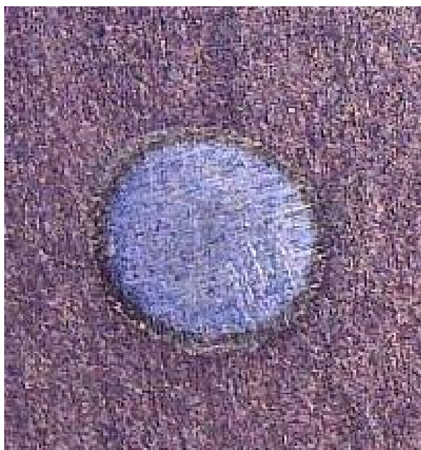
Slika 27. Ispitivanje kalotestom na TiCN prevlaci nastalom PVD postupkom
