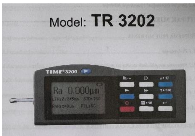
Slika 11. Elektromehanički uređaj s ticalom TR 3202 za ispitivanje hrapavosti površine
