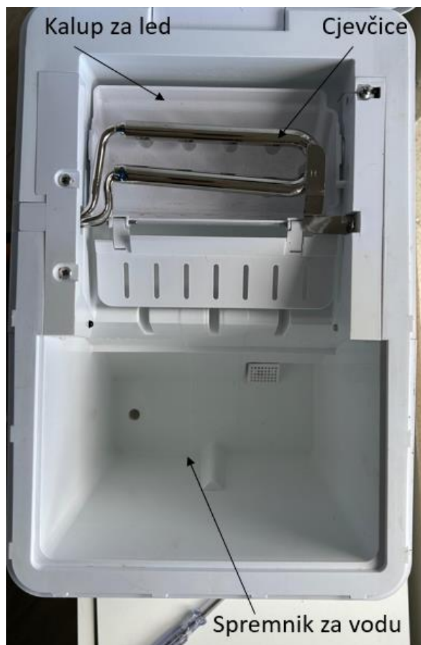
Slika 6. Dijelovi uređaja za proizvodnju leda
