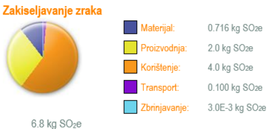
Slika 26. Zakiseljavanje zraka nakon promjena na kondenzatoru
