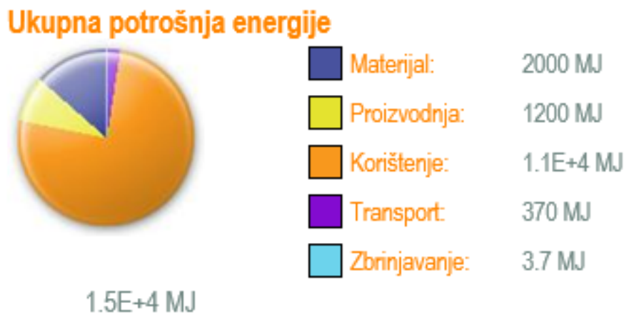
Slika 20. Ukupna potrošena energija nakon promjena na kompresoru
