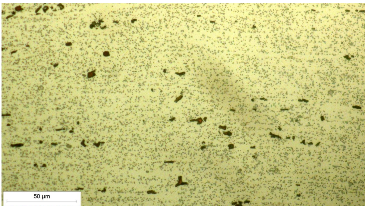
Slika 26 Osnovni materijal EN AW 6082 nakon žarenja, 500x
