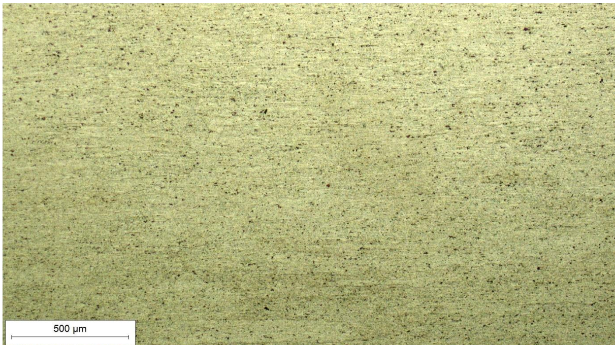
Slika 25 Osnovi materijal EN AW 6082 nakon žarenja, 50x
