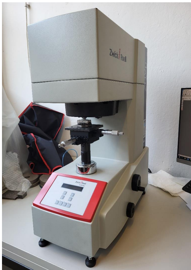
Slika 19 Mjerenje tvrdoće tvrdomerom Zwick/Roell
