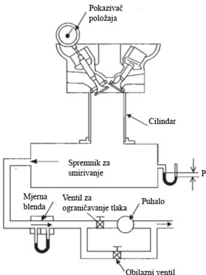
Slika 10. Shema ispitne stanice za mjerjenje karakteristika protoka [2].
