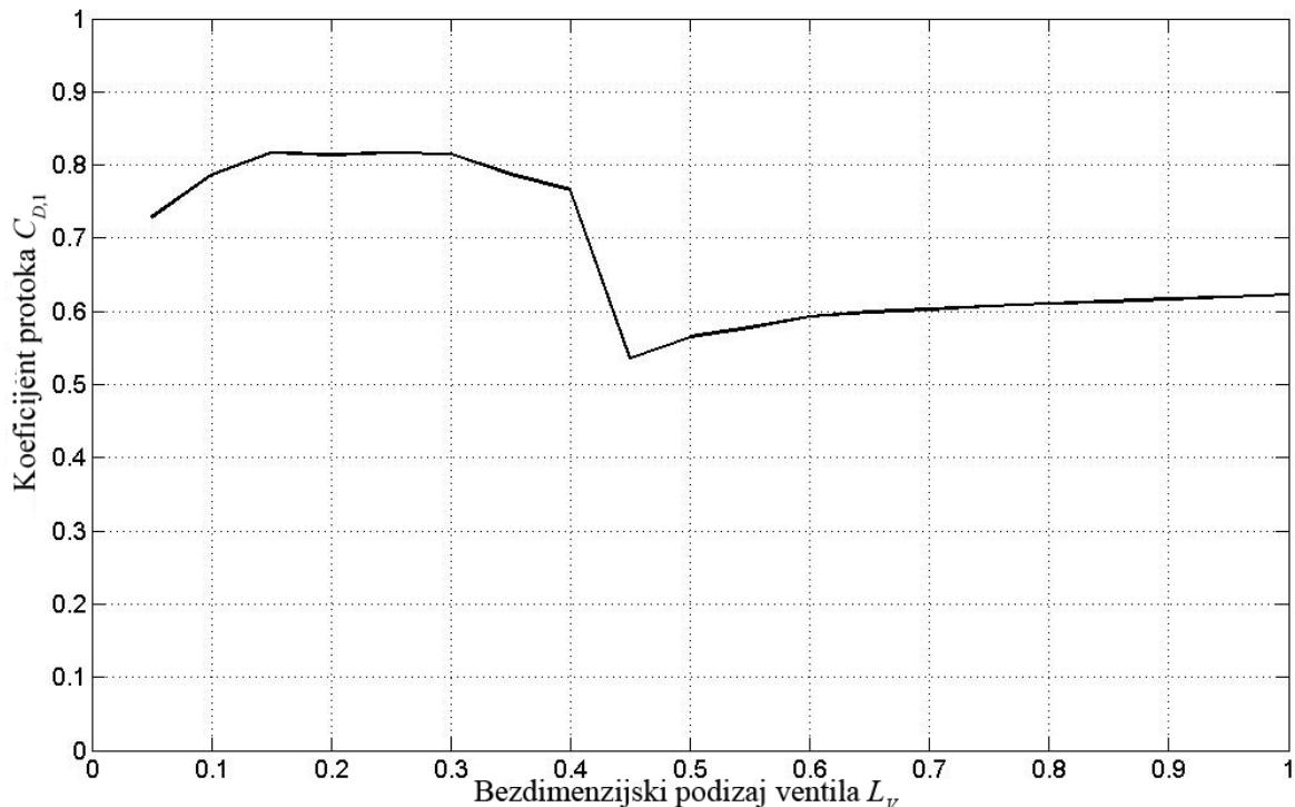
Slika 18. Prikaz izračunatog koeficijenta protoka  $C_{D,1}$ .
