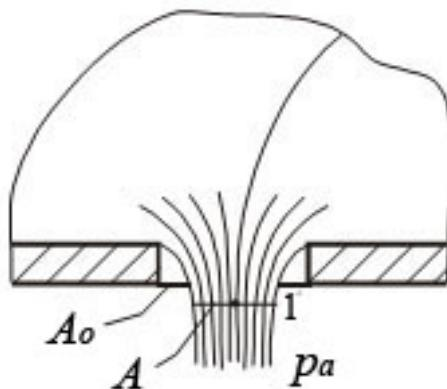
Slika 6. Prikaz strujanja fluida kroz otvor [4].
