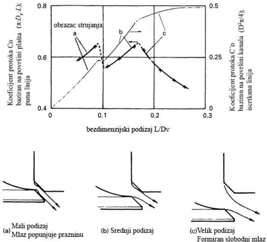
Slika 2. Karakteristika protoka oštrobridnih usisnih ventila [1].
