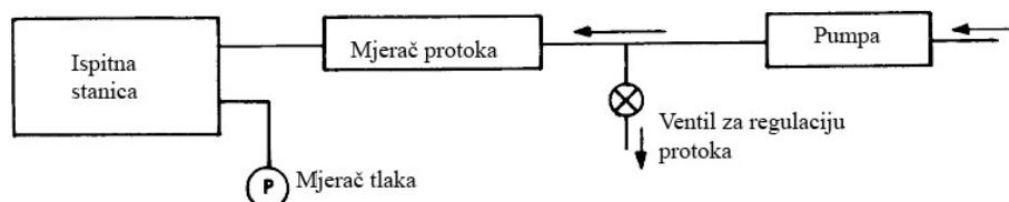
Slika 14. Shema instalacije za mjerjenje propusnosti [7].
