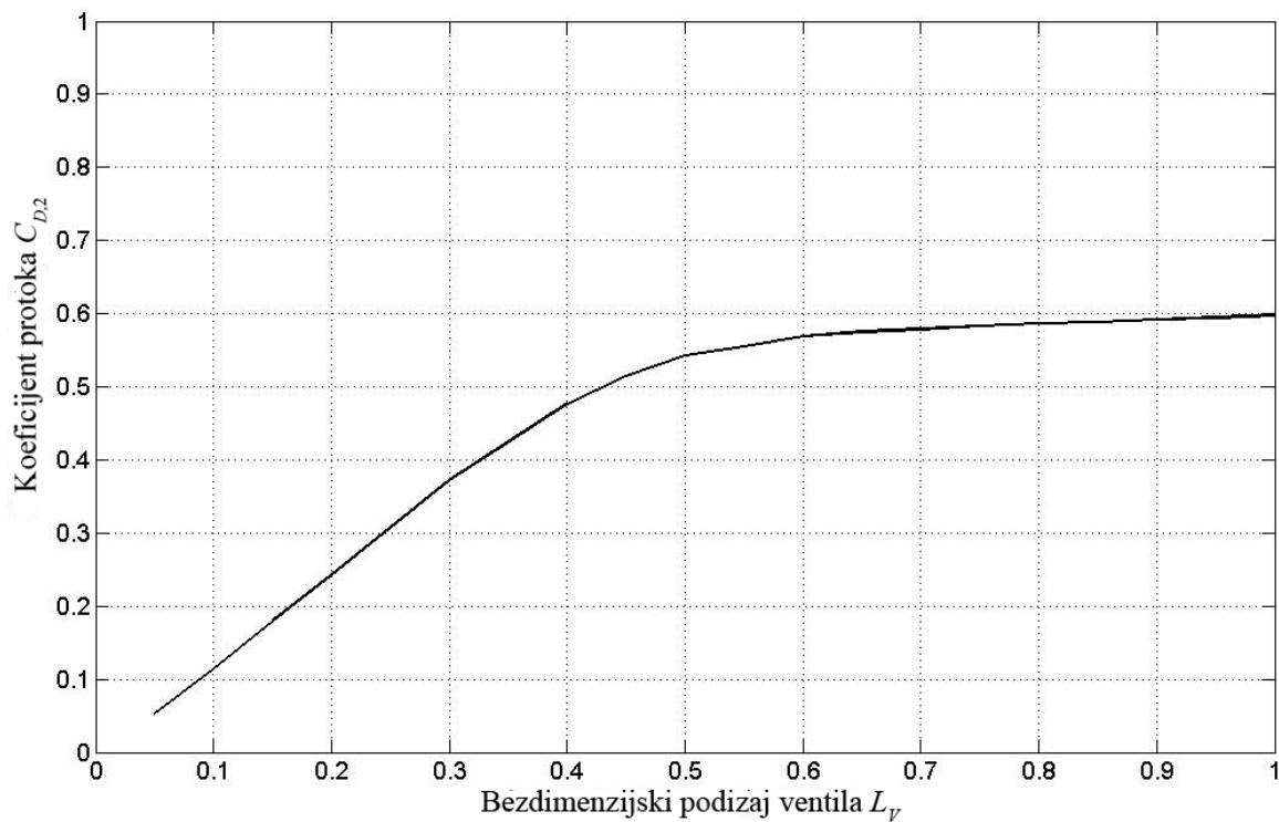
Slika 19. Prikaz izračunatog koeficijenta protoka  $C_{D,2}$ .
