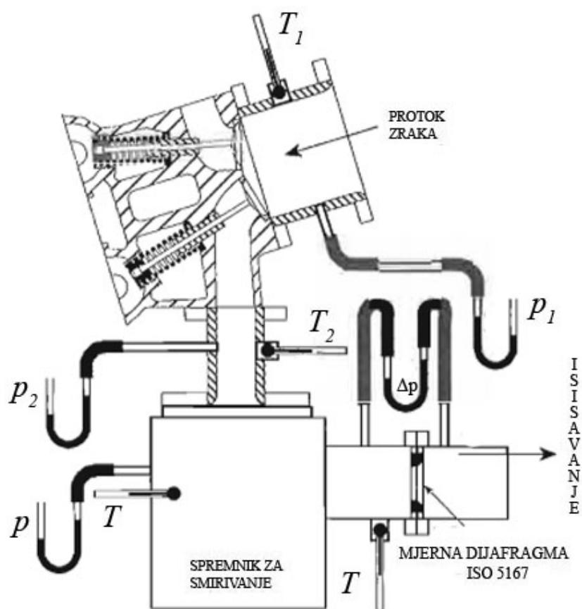
Slika 13. Uredaj za mjerjenje koef. protoka za istjecanje kroz ventile [5].
