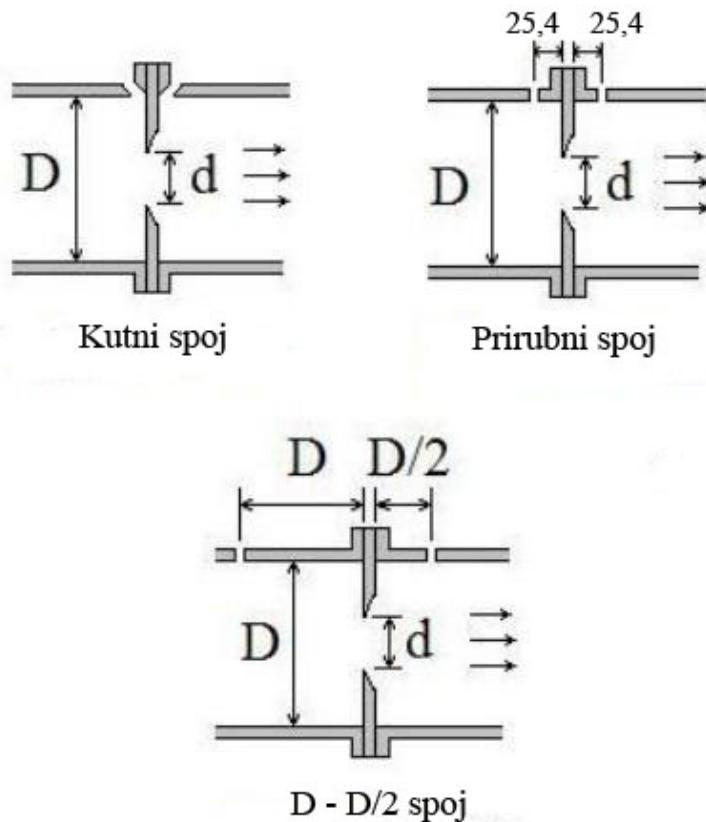
Slika 17. Standardni spojevi za diferencijalni manometar na mjernoj dijafragmi [9].
