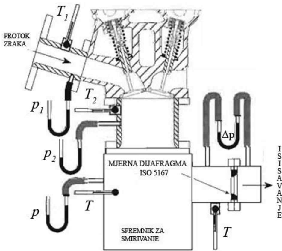
Slika 12. Uređaj za mjerjenje koef. protoka za utjecanje kroz ventile [5].
