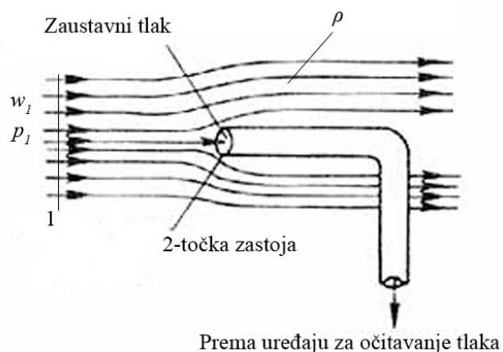
Slika 15. Shema mjerjenja zaustavnog tlaka Pitotovom cijevi [8].
